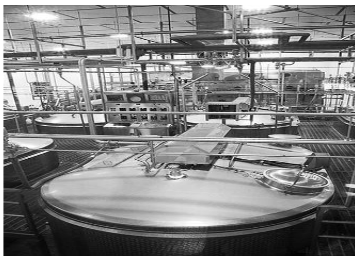
Εικόνα 5. Εσωτερικό τυρολέβητα μονάδας παραγωγής χαλουμιού με τυροκόπτες.
