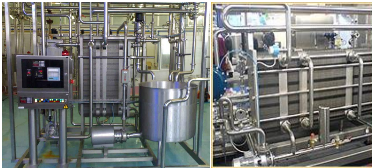
Εικόνα 4. Πλακοειδείς εναλλάκτες θερμότητας σε τυροκομική μονάδα.
