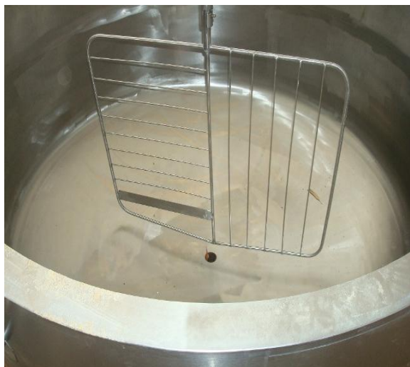
Εικόνα 5. Εσωτερικό τυρολέβητα μονάδας παραγωγής χαλουμιού με τυροκόπτες.
