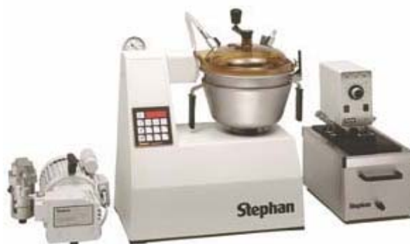
Σχήμα 3. Συσκευή ανάμιξης με ταυτόχρονη θέρμανση, υπό κενό (Stephan, Germany).
