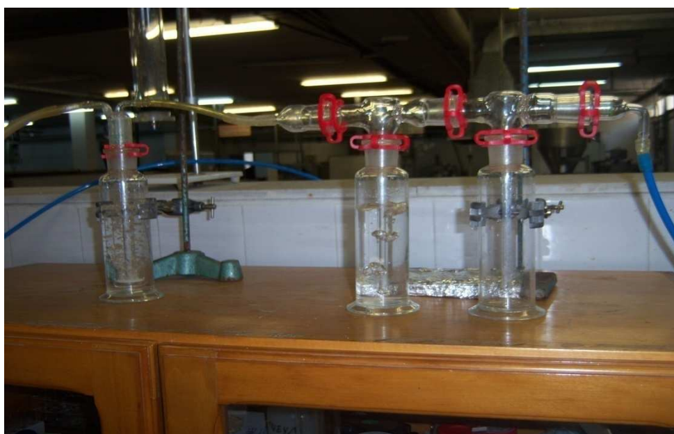
Εικόνα 2. Παγίδες αερίου με διάλυμα KI 2%, για τη δέσμευση του \text{O}_3
