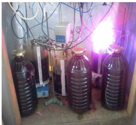
Σχήμα 5. Συστήματα ενεργού ιλύος εργαστηριακής κλίμακας
