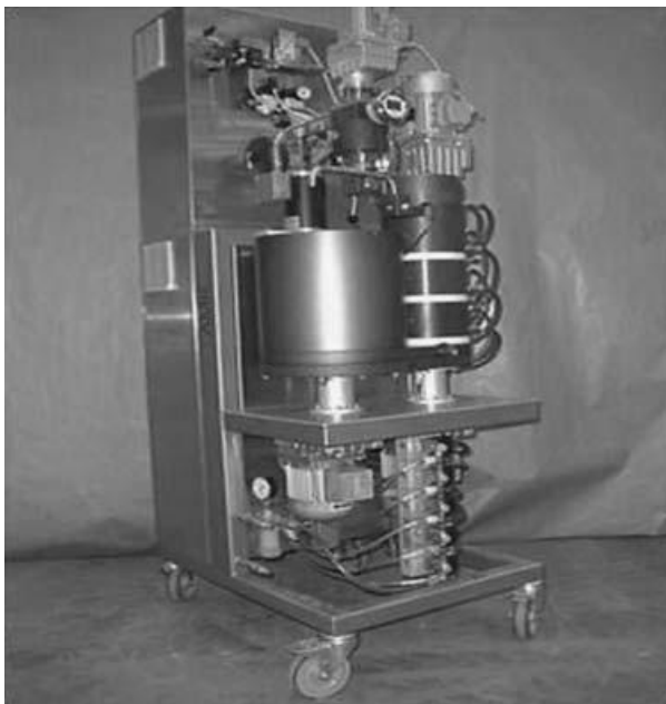
Σχήμα 9. Εργοστασιακό μηχάνημα για tempering (Afoakwa, 2010)
