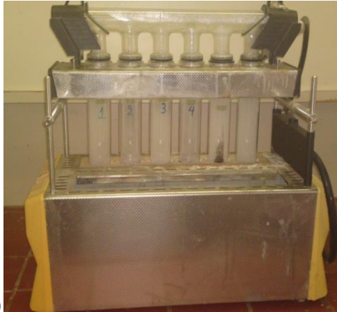
Σχήμα 10: (α): Συσκευή καύσης Kjeldahl, (β): Συσκευή απόσταξης Kjeldahl
