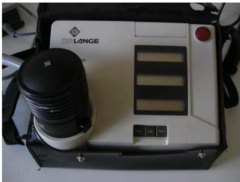
Σχήμα 12: Χρωματομέτρο μοντέλου Micro Color (Dr. Lange, Germany), τύπου Hunter
