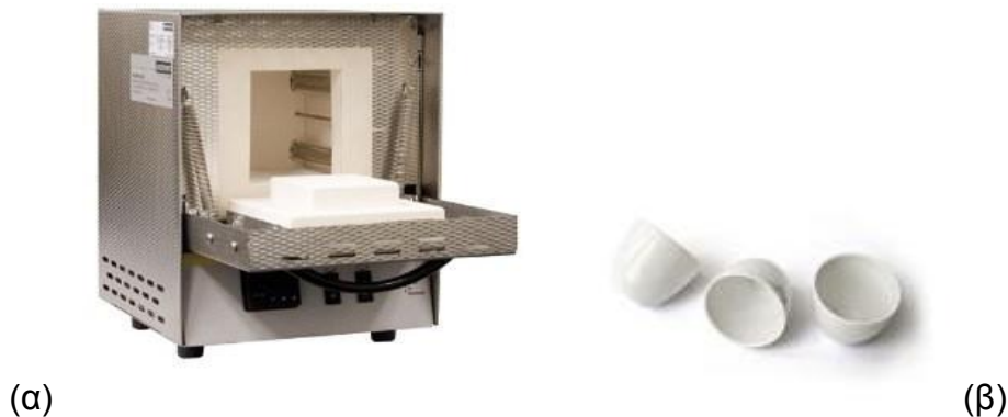
Σχήμα 8: (α): Πυραντήριο, (β): Κάψες πορσελάνης
