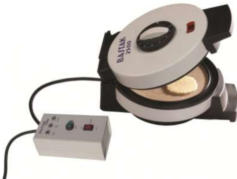
Εικόνα 7: Τοστιέρα εργαστηρίου που χρησιμοποιείται για την ξήρανση υγρής γλουτένης
