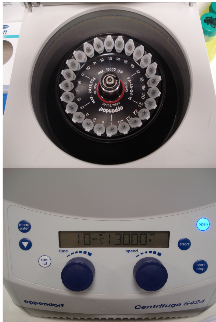
Εικόνα 5.7. Φυγόκεντρος 24 θέσεων για μικροφιαλίδια των 1,5μl και 2μl που χρησιμοποιήθηκε για το διαχωρισμό διαλυμάτων εκχύλισης DNA.
