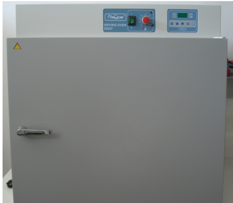
Εικόνα 5.18. Ξηρός κλίβανος που χρησιμοποιήθηκε για την αποστείρωση μικροεργαλείων, γυαλικών κ.ά. αντικειμένων που χρησιμοποιούνται στην ιστοκαλλιέργεια.
