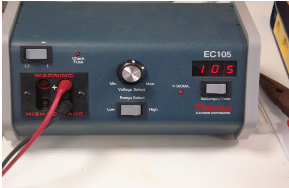
Εικόνα 5.14. Τροφοδοτικό παροχής ηλεκτρισμού σε μεταβαλλόμενη τάση για τη λειτουργία της επιτραπέζιας ηλεκτροφόρησης.
