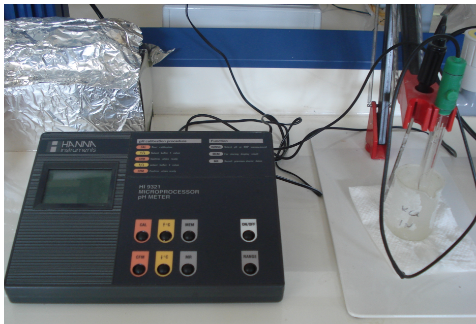
Εικόνα 5.19. pH-μετρο για τη μέτρηση της οξύτητας του θρεπτικού υποστρώματος.
