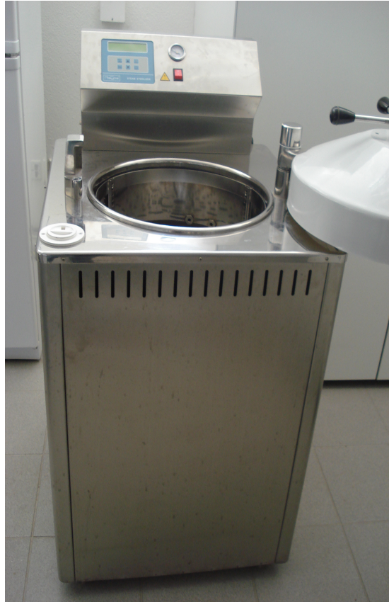
Εικόνα 5.15. Υγρός κλίβανος για την αποστείρωση του θρεπτικού υποστρώματος που είναι τοποθετημένο στα βαζάκια.
