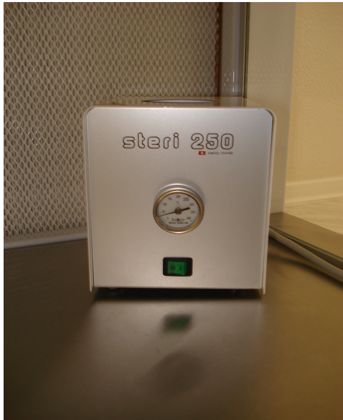
Εικόνα 5.17. Επιτραπέζιος αποστειρωτής ξηρού τύπου που χρησιμοποιήθηκε για την αποστείρωση των εργαλείων κατά τη διαδικασία της ιστοκαλλιέργειας αγριογαρυφάλων η οποία βρίσκεται μέσα στην τράπεζα εργασίας.
