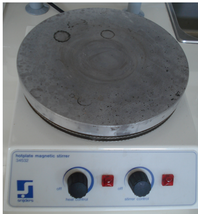
Εικόνα 5.20. Θερμική εστία και Μαγνητικός αναδευτήρας για τη παρασκευή του θρεπτικού υποστρώματος.
