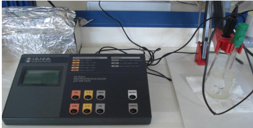
Εικόνα 4.5. pH-μετρο για τη μέτρηση της οξύτητας του θρεπτικού υποστρώματος.
