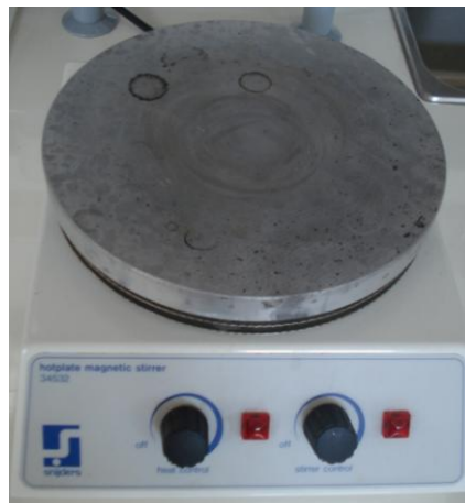
Εικόνα 4.6. Θερμική εστία και Μαγνητικός αναδευτήρας για τη παρασκευή του θρεπτικού υποστρώματος.
