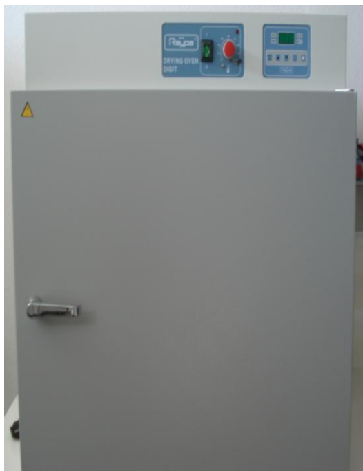
Εικόνα 4.4. Ξηρός κλίβανος που χρησιμοποιήθηκε για την αποστείρωση μικροεργαλείων, γυαλικών κ.ά. αντικειμένων που χρησιμοποιούνται στην ιστοκαλλιέργεια.
