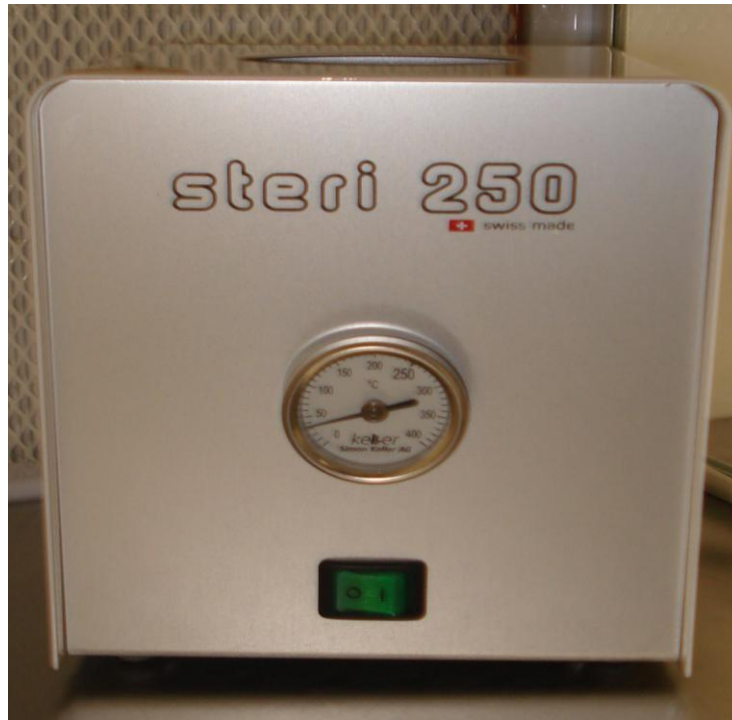
Εικόνα 4.3. Επιτραπέζιος αποστειρωτής ξηρού τύπου που χρησιμοποιήθηκε για την αποστείρωση των εργαλείων κατά τη διαδικασία της ιστοκαλλιέργειας η οποία βρίσκεται μέσα στην τράπεζα εργασίας.
