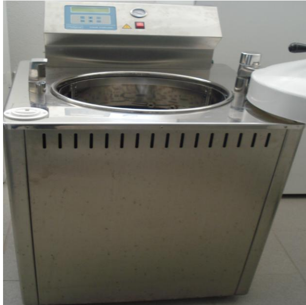
Εικόνα 4.1. Υγρός κλίβανος για την αποστείρωση του θρεπτικού υποστρώματος που είναι τοποθετημένο στα βαζάκια.
