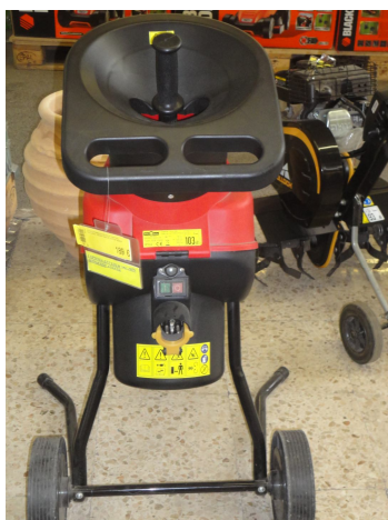
Εικ.107(Ηλεκτρικός θρυμματιστής κλαδιών – κλαδοφάγος,Α.Μ)
