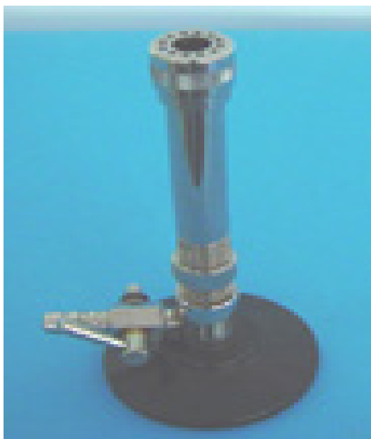
Εικ.67: Λύχνος Bunsen με στρόφιγγα Όμοιος με τον προηγούμενο, διαθέτει και στρόφιγγα διακοπής παροχής. [38]
