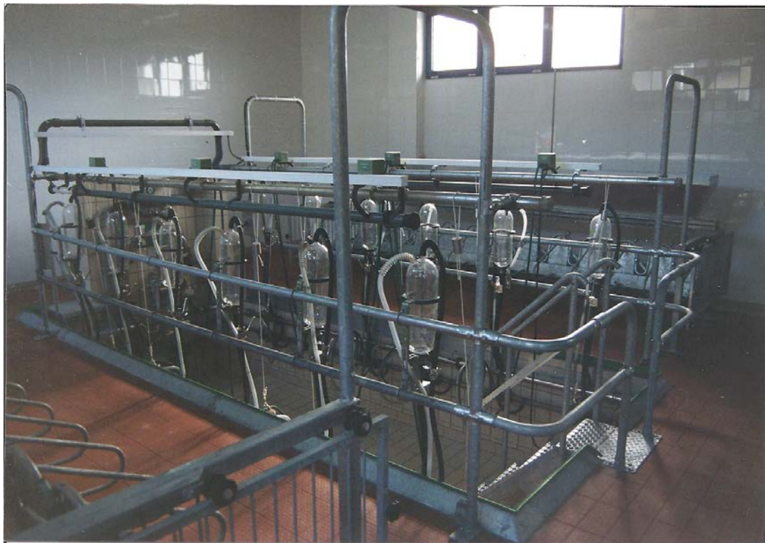
Εικ.21 Το πρώτο αρμεκτικό συγκρότημα της εκμετάλλευσης. Παλινδρομικό 24 (2 Χ12) θέσεων (1 : 2) με φιάλες γαλακτομέτρησης.
