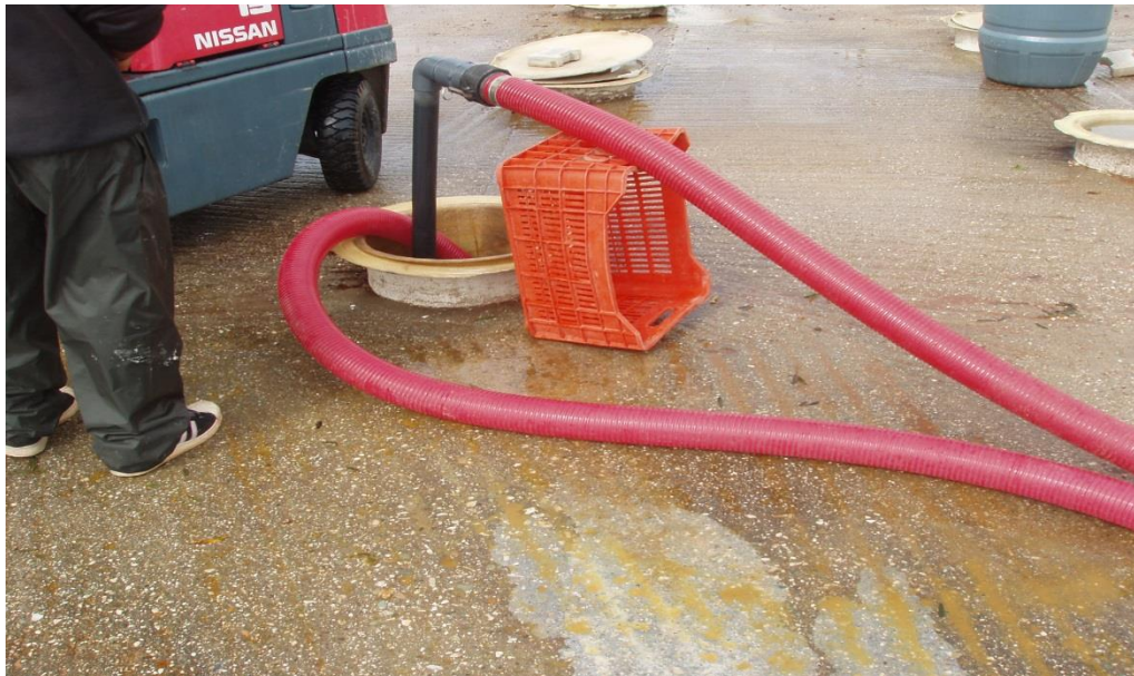
(Εικόνα5) Απεικονίζονται δύο σωλήνες τροφοίμων ο ένας για την είσοδο του νερού και ο άλλος για την έξοδο.
