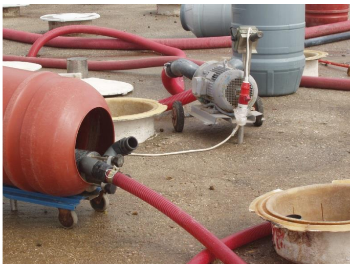
(Εικόνα 6) Απεικονίζονται οι αντλίες που δίνουν νερό και τραβάνε νερό από τις δεξαμενές.
