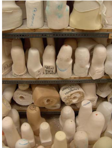
Εικόνα 39. Καλούπια για την κατασκευή θηκών
