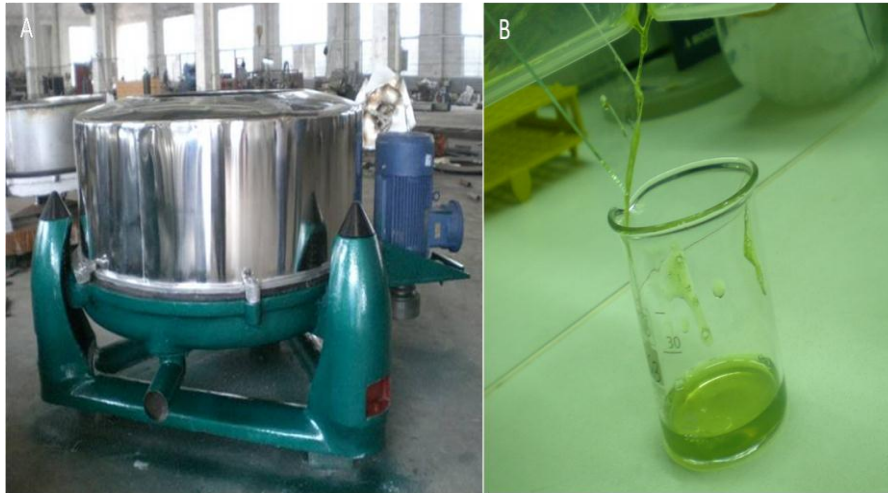
Εικόνα 13. Α. Φυγόκεντρος βιομηχανικής κλίμακας για την λήψη βλέννας από σαλιγκάρια (Πηγή: Zhengzhou Toper Industrial Equipment Co.,Ltd ) Β. Βλέννα που λαμβάνεται από τη φυγοκέντρηση σε εργαστηριακή κλίμακα (πηγή: Εργαστήριο Ζωολογίας ΑΠΘ).
