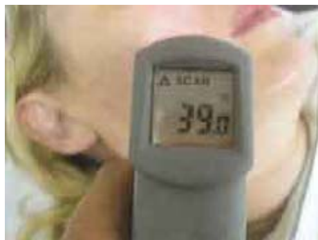
Σχ.1.4 Λέιζερ υπέρυθρο θερμόμετρο για την καταγραφή της επιδερμικής θερμοκρασίας.
