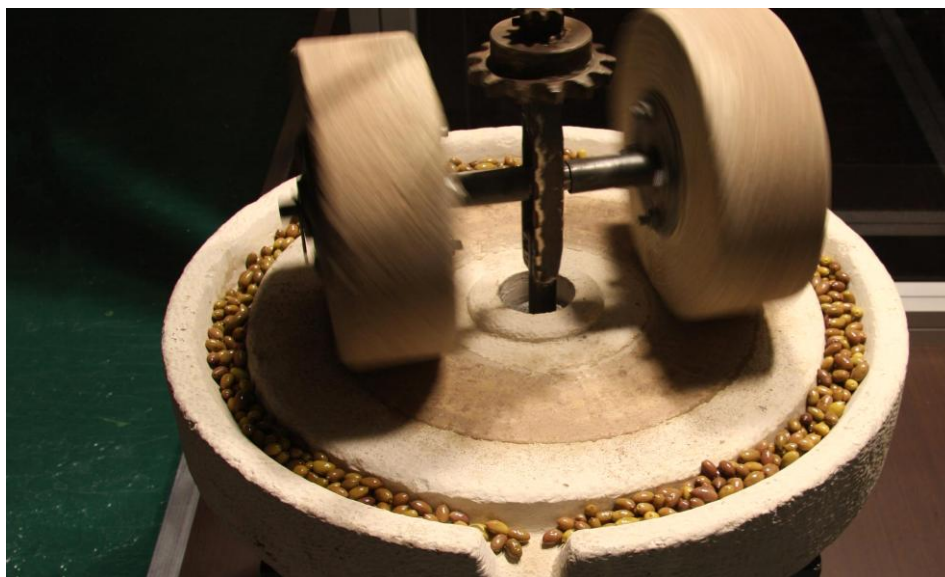
Εικόνα 7: Παραδοσιακό μηχάνημα ελαιοτριβείου
