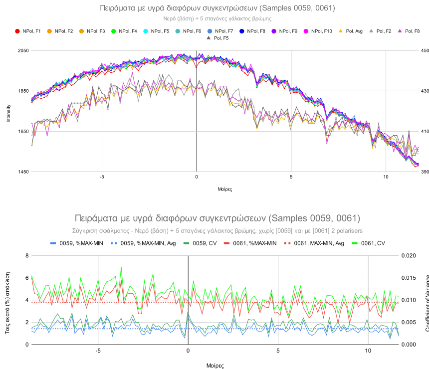
Σχήμα 6.2.9: Πείραμα με 5 σταγόνες γάλακτος βρώμης, με και χωρίς πολωτές (επάνω). Σύγκριση στη σφάλματος ανά pixel μεταξύ των δύο δειγμάτων (κάτω).
