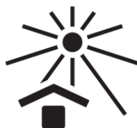
Σχήμα 17.0.4: Σύμβολο για διατήρηση του προϊόντος μακριά από τον ήλιο. Αυτό το σύμβολο σύμφωνα με το ISO 7000 μπορεί επίσης να σημαίνει «Κρατήστε μακριά από θερμότητα».
