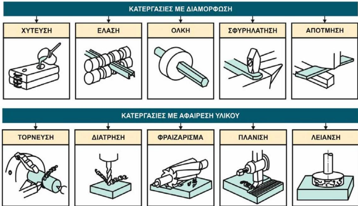
Εικόνα 9. Κατηγορίες Κατεργασίας στο Φάσμα της Μηχανουργικής Τεχνολογίας.
