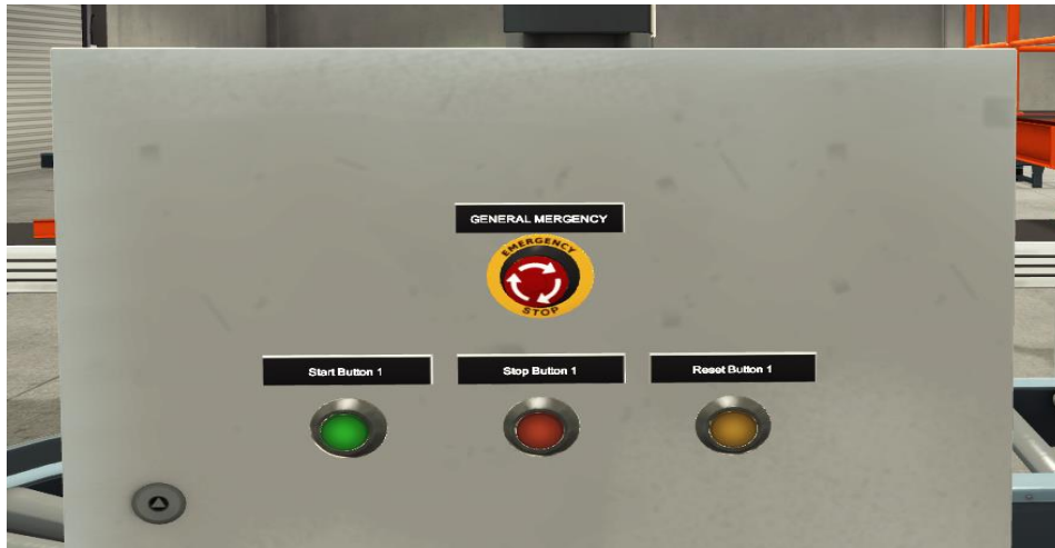
Εικόνα 27: Κεντρικός πίνακας χειρισμών όλου του αυτοματισμού.
