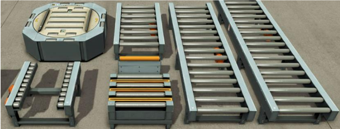
Εικόνα 4: Γενική εικόνα των ραουλόδρομων μεταφοράς βαρέων αντικειμένων του προγράμματος.
