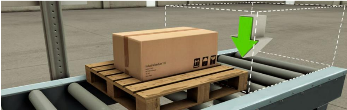
Εικόνα 6: Σταθμοί τοποθέτησης και απόθεσης προϊόντων.
