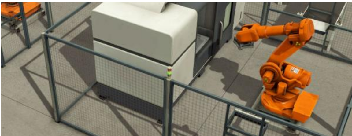
Εικόνα 12: Κελί (Cell) με κέντρο κατεργασίας.
