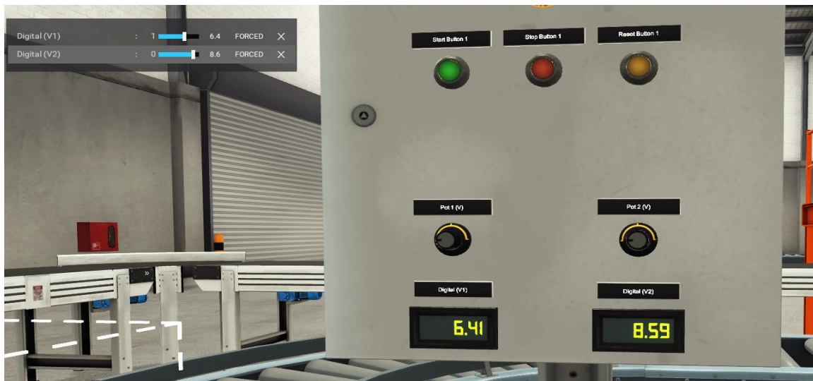
Εικόνα 42: Function Block 5 ποτενσιόμετρα χειρισμού αναλογικών σημάτων.
