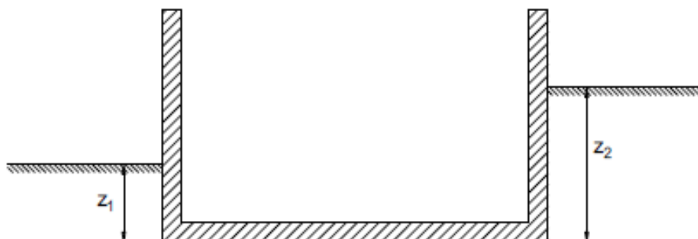
Σχήμα 8: Ενδεικτική διατομή κτιρίου για τον προσδιορισμό του βάθους έδρασης πλάκας επί εδάφους με διαφορετικές στάθμες έδρασης λόγω κεκλιμένου εδάφους (Τ.Ο.Τ.Ε.Ε, 2017)
