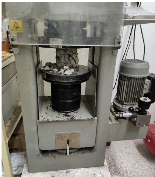
Εικόνα 38: Συσκευή προσδιορισμού αντοχής σε θλίψη, συμβατή με το πρότυπο EN 12390-4
