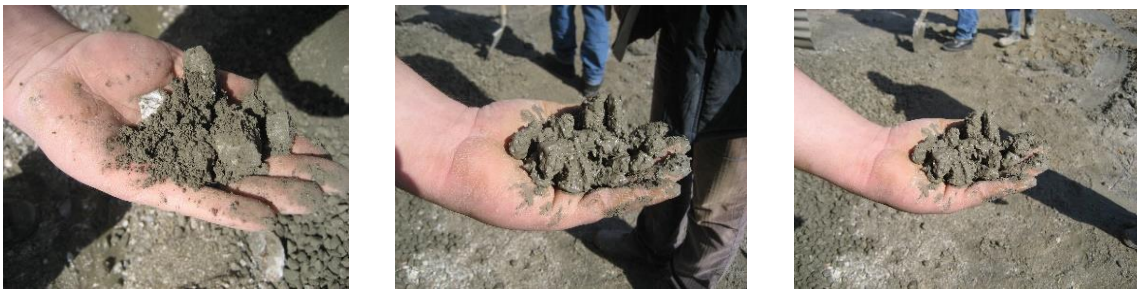
Εικόνα 3: Δοκιμαστικά Αναμείγματα με διαφορετικά ποσά νερού : Ύφυγρο – Αποδεκτό - Υδαρές
