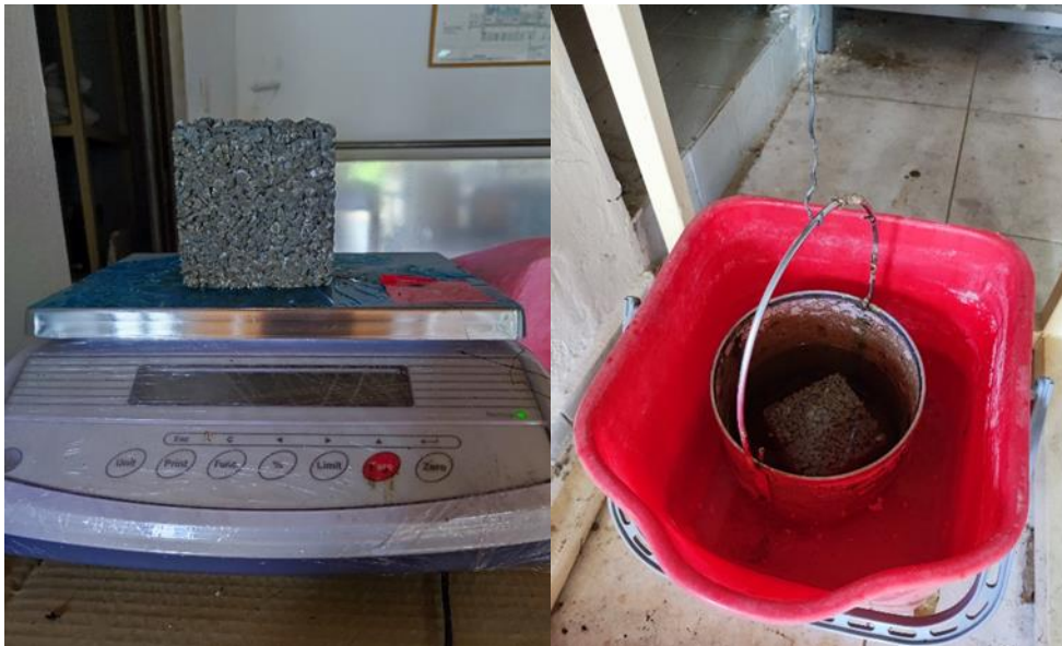
Εικόνα 31: Φαινόμενο βάρος δοκιμίου και βάρος δοκιμίου στο νερό
