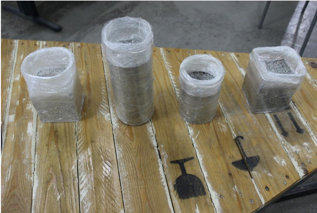
Εικόνα 34: Προετοιμασία δοκιμίων για δοκιμή με ISO Infiltration System
