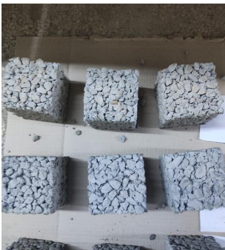
Εικόνα 43: Δοκίμιο διαπερατού σκυροδέματος D_{max} 16mm
