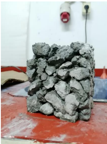
Εικόνα 42: Δοκίμιο διαπερατού σκυροδέματος D_{max} 31,5mm
