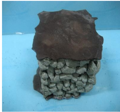
Εικόνα 40: Συσκευή καπέλώματος και καπέλωμα δοκιμίου
