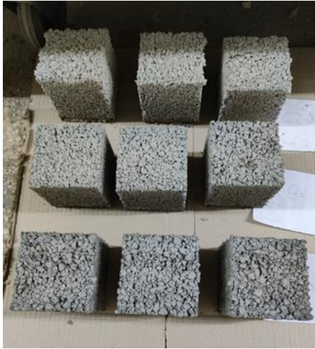
Εικόνα 44 : Δοκίμιο διαπερατού σκυροδέματος D_{max} 8mm
