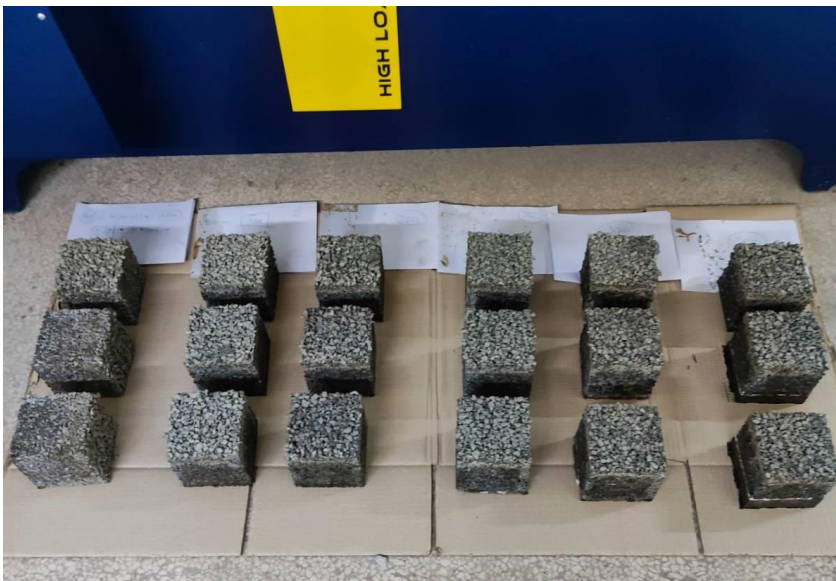
Εικόνα 47: Δοκίμια με D_{max}=8\text{mm} και coarse to fine ratio 100/0
