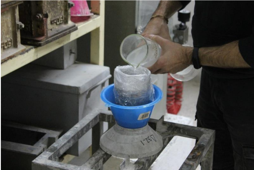
Εικόνα 35: Διαδικασία δοκιμής με ISO Infiltration System
