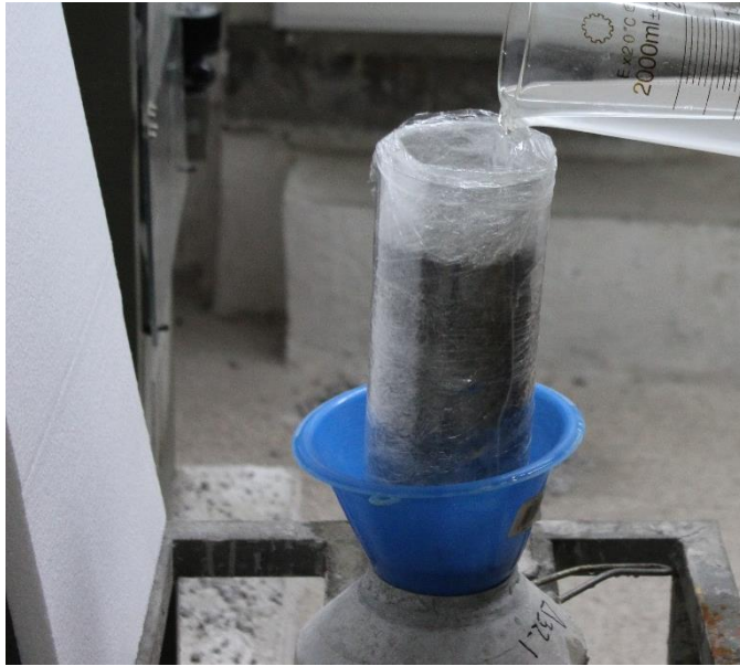
Εικόνα 32: Εργαστηριακή διάταξη ISO 17785-1
