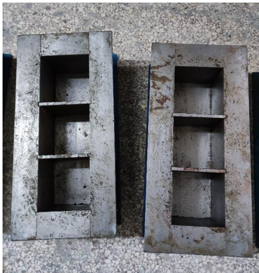
Εικόνα 25: Κυβικές μεταλλικές μήτρες 10\text{cm}^3
