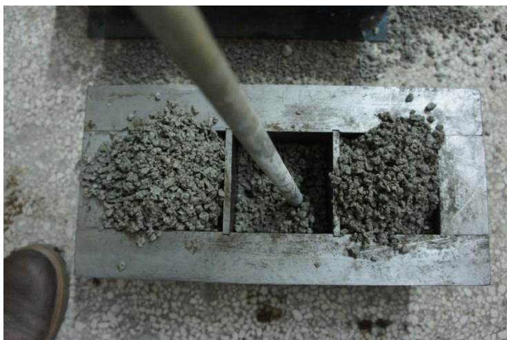
Εικόνα 27: συμπύκνωση διαπερατού σκυροδέματος
