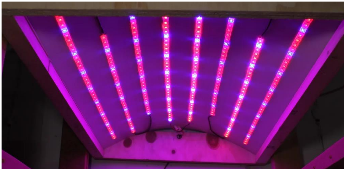
Εικόνα 5.1 Grow Light συστοιχία LED
