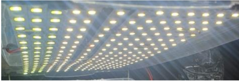
Εικόνα 3.12 Συστοιχία LED του θαλάμου καλλιέργειας
