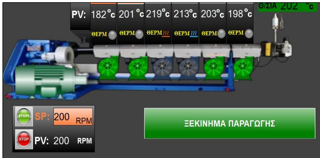
Εικόνα 4-23 Απεικόνιση εκκίνησης extruder
