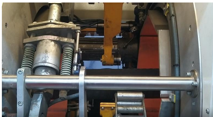
Εικόνα 2-16 Περιστροφικό τύμπανο με έμβολο συγκράτησης δίσκου κοπής
