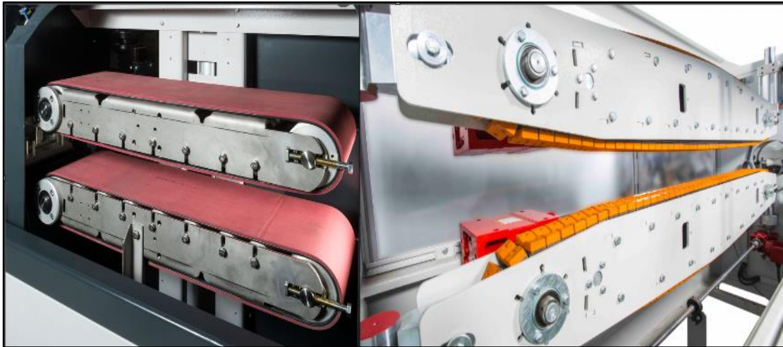
Εικόνα 2-12 Μηχανές Haul Off με ιμάντες και ερπύστριες
