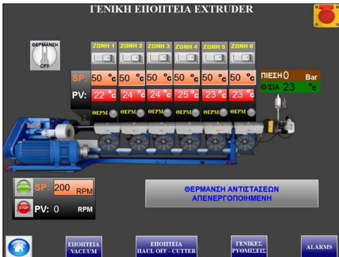
Εικόνα 4-17 Οθόνη γενικής εποπτείας Extruder
