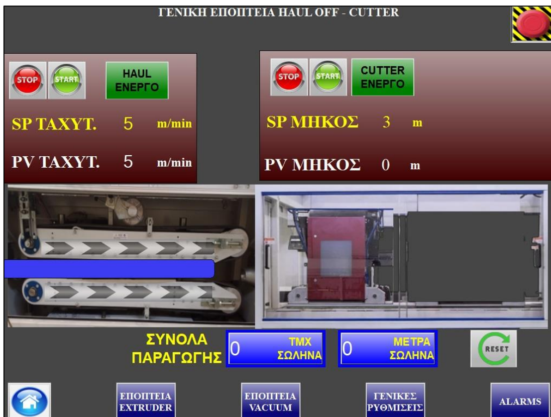
Εικόνα 4-26 Οθόνη εποπτείας haul off και κοπτικού
