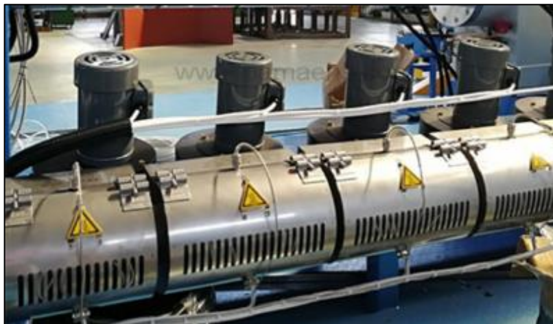
Εικόνα 2-3 Ζώνες θέρμανσης extruder
