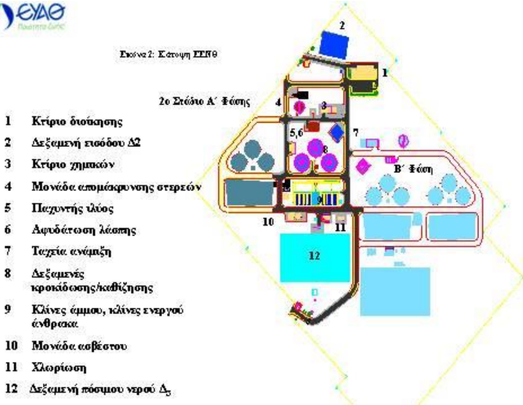
Εικόνα 2: Κάτοψη εγκατάστασης της ΕΕΝΘ (Σερετούδη Γεωργία, 2012)
