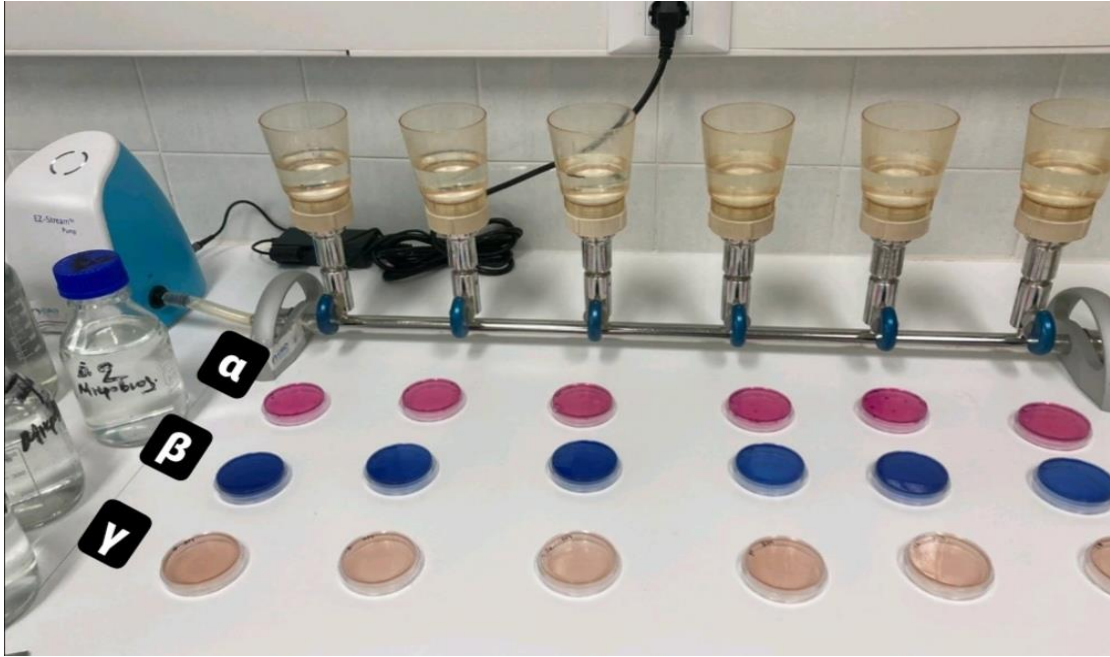
Εικόνα 5: Διάταξη διήθησης δειγμάτων νερού (συσσκευή διήθησης, αντλία κενού) και τριβλία με θρεπτικό υλικό (α) για ολικά κολοβακτηρίδια κόκκινο υπόστρωμα- M-Endo Agar (β) για Escherichia μπλε υπόστρωμα-MFC Agar (γ) για εντερόκοκκους
