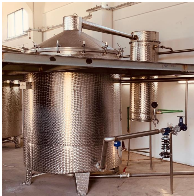
Εικόνα 13: Άμβυκας ανοξείδωτου χάλυβα σε σύγχρονο αποστακτήριο, Πηγή: Ιδία από προσωπική φωτογράφιση
