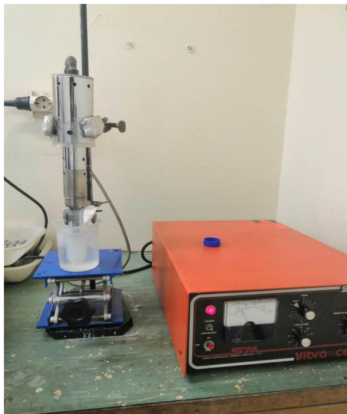
Εικόνα 15: Το μηχάνημα του ηχητικού ανιχνευτή (Probe Sonicator)
