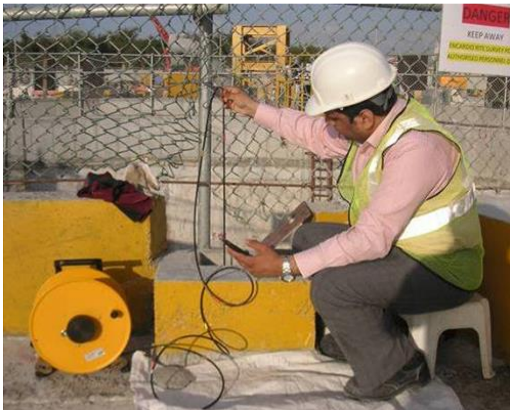
Εικόνα 7: Όργανο παρακολούθησης κλίσης, Πηγή: (Encardio, n.d.)
