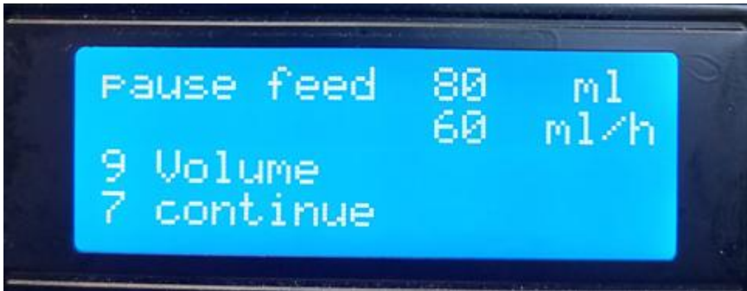
Εικόνα 6.7: Λειτουργία προσωρινής διακοπής σίτισης
