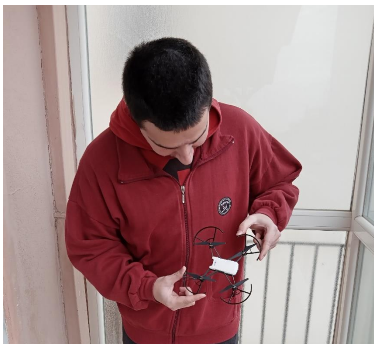
Εικόνα 80: Έλεγχος και επιθεώρηση των ελίκων-στροφείων και των κινητήρων του ΣμηΕΑ (Πηγή: Παπαδόπουλος Κωνσταντίνος)
