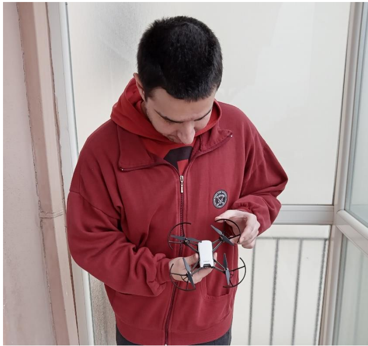
Εικόνα 81: Έλεγχος και επιθεώρηση του μπροστινού και πίσω μέρους της ατράκτου του ΣμηΕΑ (Πηγή: Παπαδόπουλος Κωνσταντίνος)
