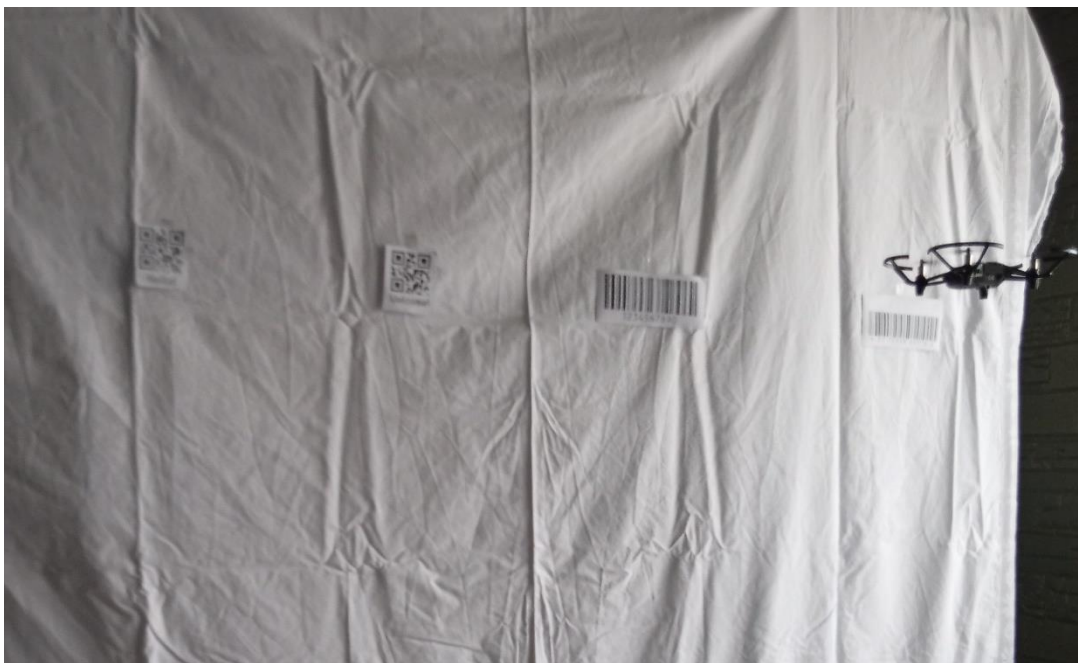
Εικόνα 97: Πτήση αναγνώρισης και σκανάριατος barcodes και QR codes (Πηγή: Παπαδόπουλος Κωνσταντίνος)
