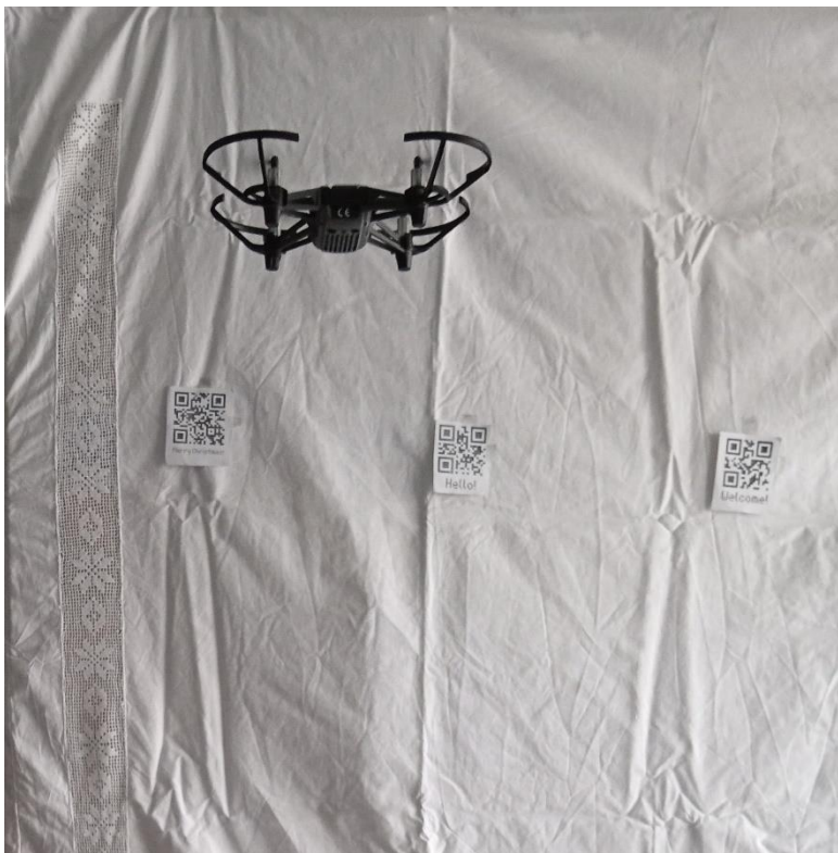
Εικόνα 93: Πτήση αναγνώρισης και σκανάρισματος barcodes και QR codes (Πηγή: Παπαδόπουλος Κωνσταντίνος)
