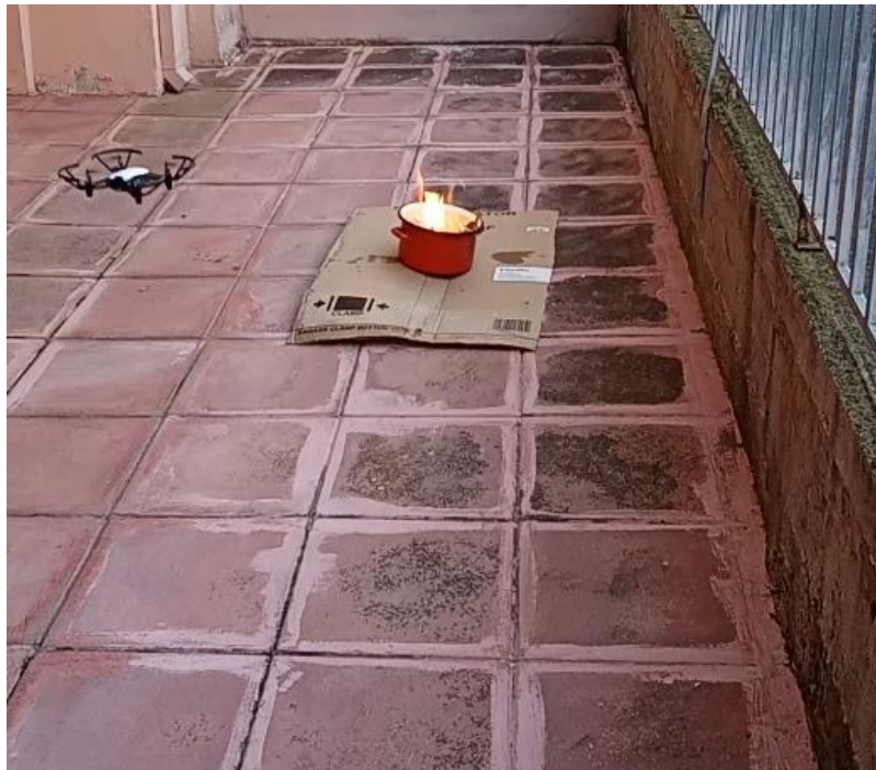
Εικόνα 108: Πτήση ανίχνευσης καπνού – πυρκαγιάς από το ΣμηΕΑ (Πηγή: Παπαδόπουλος Κωνσταντίνος)
