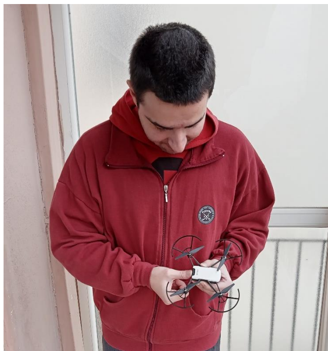
Εικόνα 85: Ασφάλιση της μπαταρίας στο ΣμηΕΑ (Πηγή: Παπαδόπουλος Κωνσταντίνος)
