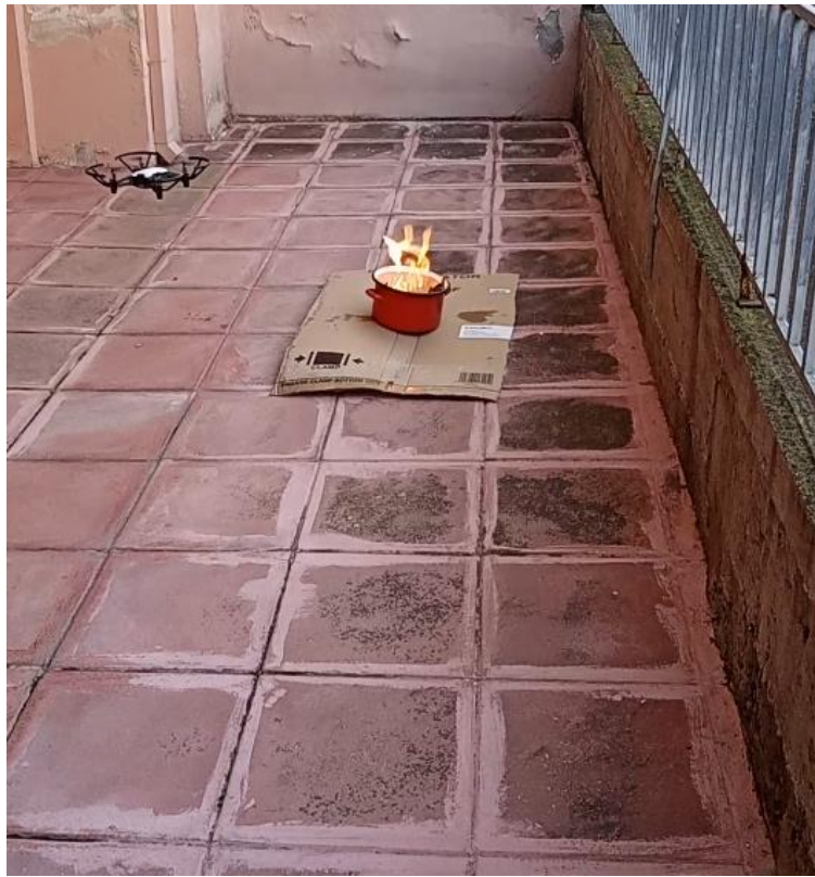
Εικόνα 110: Πτήση ανίχνευσης καπνού – πυρκαγιάς από το ΣμηΕΑ (Πηγή: Παπαδόπουλος Κωνσταντίνος)
