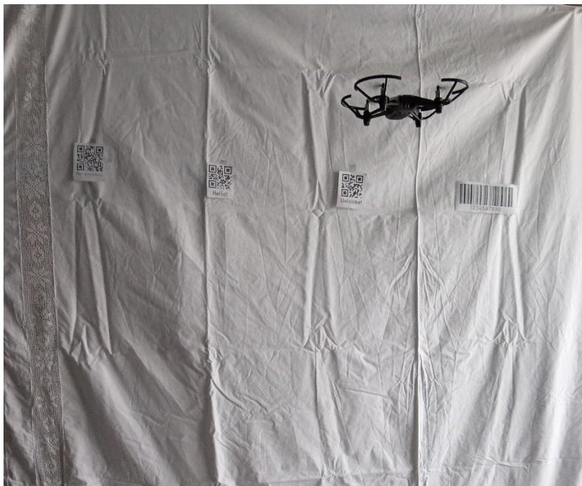
Εικόνα 95: Πτήση αναγνώρισης και σκανάρισματος barcodes και QR codes (Πηγή: Παπαδόπουλος Κωνσταντίνος)
