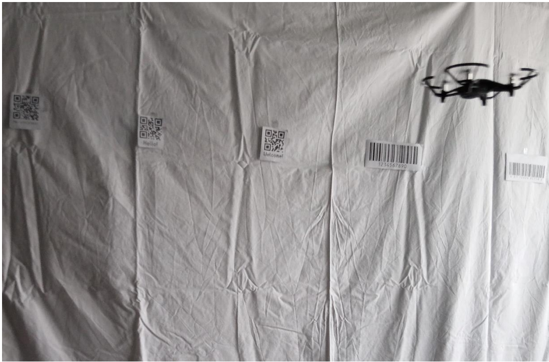
Εικόνα 96: Πτήση αναγνώρισης και σκανάριατος barcodes και QR codes (Πηγή: Παπαδόπουλος Κωνσταντίνος)
