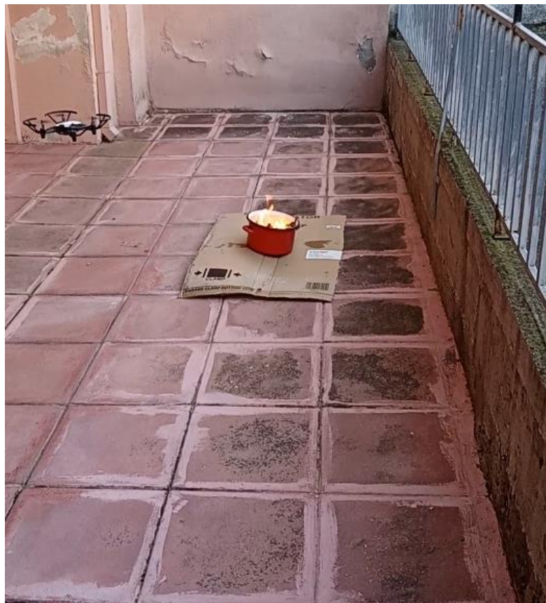
Εικόνα 109: Πτήση ανίχνευσης καπνού – πυρκαγιάς από το ΣμηΕΑ (Πηγή: Παπαδόπουλος Κωνσταντίνος)
