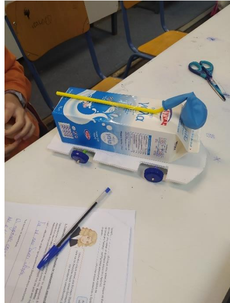
Στιγμιότυπο 6: Όχημα για τη μελέτη του τρίτου νόμου «δράσης – αντίδρασης» του Νεύτωνα (4 η ομάδα)
