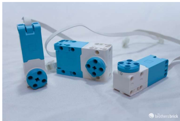
Εικόνα 5.8 Ο μεγάλος και οι μικροί κινητήρες.
