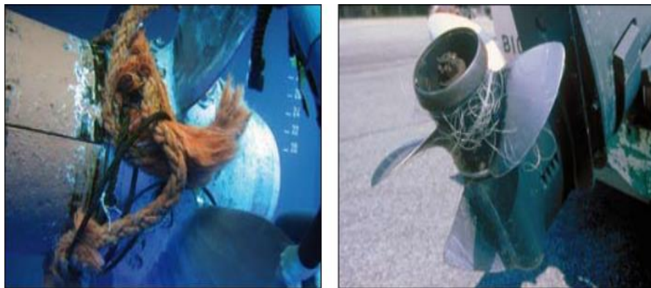
Εικόνα 34: Ζημιές στις προπέλες των σκαφών υστέρα από εμπλοκή των δικτύων αλιείας με αυτές (Macfadyen et al., 2009)
