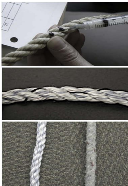
Εικόνα 58: Κωδικοποιημένες συρμάτινες ετικέτες (CWT) που εγχύθησαν στο σχοινί, ή μπήκαν μέσα σε ένα πλεγμένο σπάγκο (μαύρο νήμα), στη συνέχεια ενώθηκαν στο σχοινί και σύγκριση γραμμής που χρησιμοποιήθηκε για επιταχυνόμενη δοκιμή
