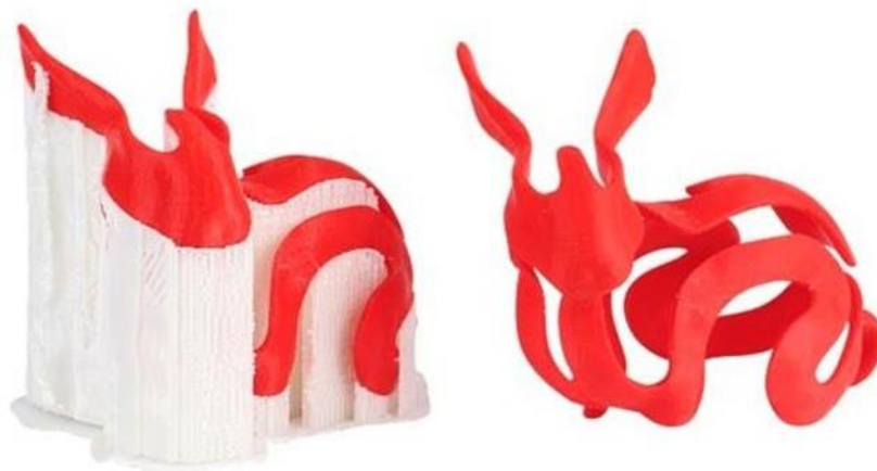
Εικόνα 86: Μια πλήρης εκτύπωση Fused Filament Fabrication (FFF) πριν από την αφαίρεση των δομών στήριξης (αριστερά) και μετά (δεξιά) (Hunt & Charter, 2016)
