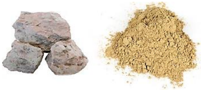
Εικόνα 3.5.2.1.1 Μπετονίτης σε μορφή πετρώματος και σκόνης
