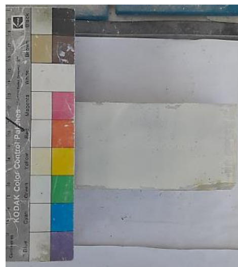
Εικόνες 4.2.17 Δοκίμια μετά την δοκιμή άμεσης διάτμησης υπό ορθή τάση 200 kPa
