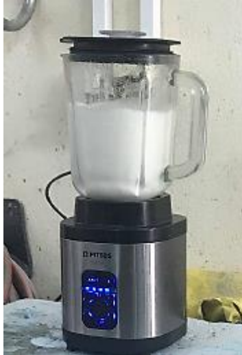
Εικόνα 3.5.4 Μπλέντερ για την ανάμιξη υλικών για την παραγωγή του ενέματος
