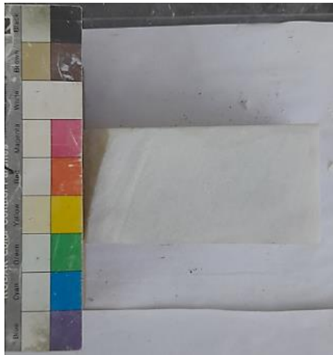
Εικόνες 4.2.10 Δοκίμια μετά την δοκιμή άμεσης διάτμησης υπό ορθή τάση 400 kPa
