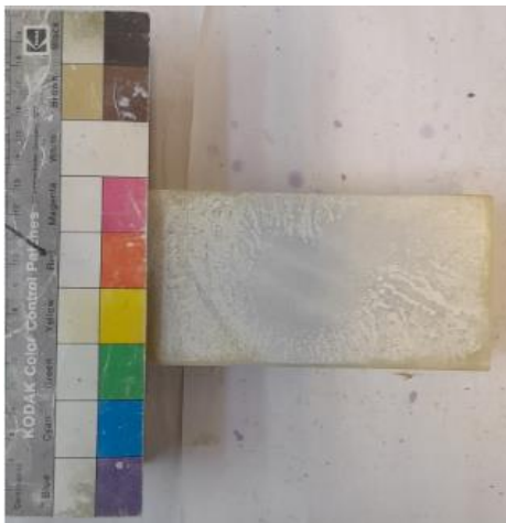
Εικόνες 4.3.3 Δοκίμια μετά την δοκιμή άμεσης διάτμησης υπό ορθή τάση 800 kPa
