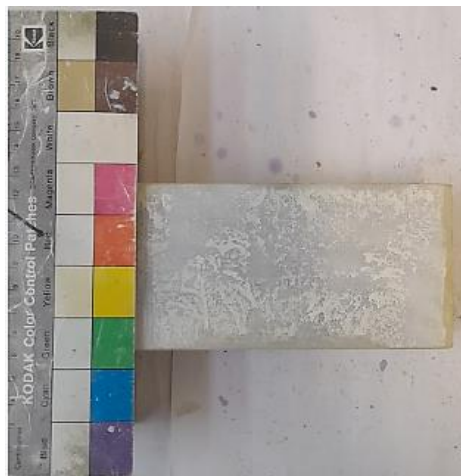
Εικόνες 4.3.1 Δοκίμια μετά την δοκιμή άμεσης διάτμησης υπό ορθή τάση 200 kPa
