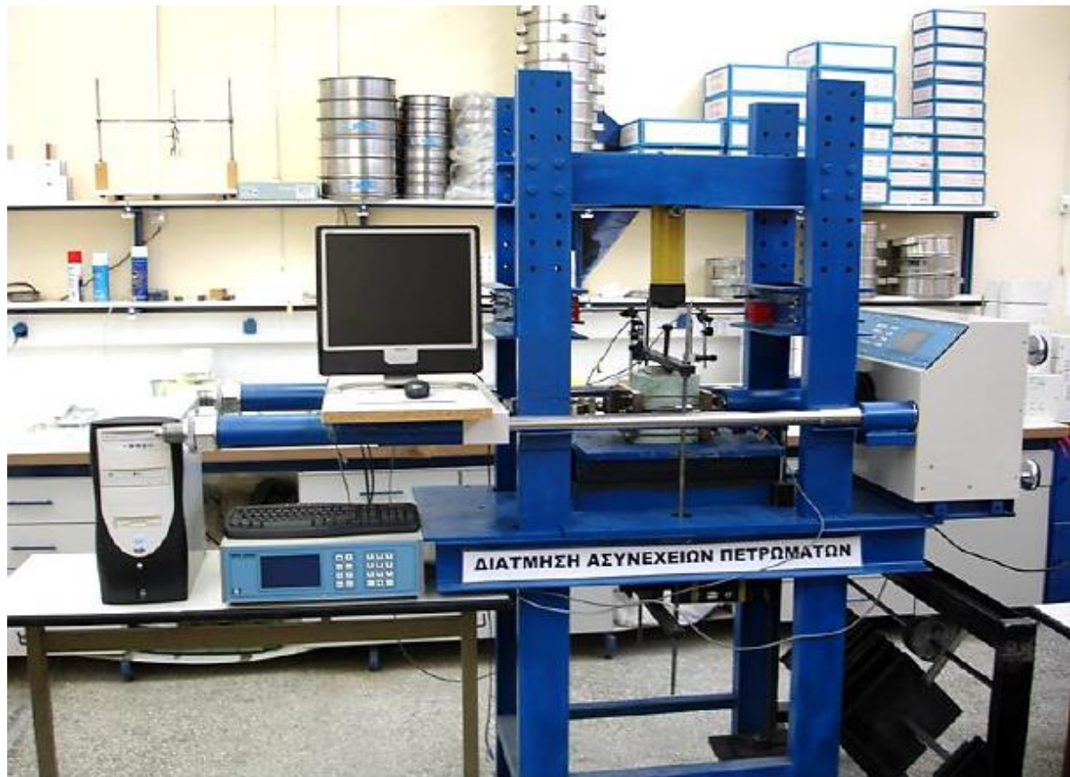
Εικόνα 3.7.2.1 Πειραματική διάταξη της συσκευής άμεσης διάτμησης ασυνεχειών πετρωμάτων και των παρελκόμενων.
