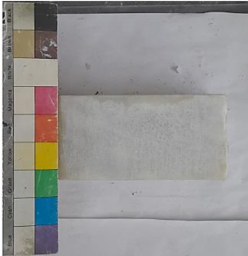
Εικόνες 4.2.5 Δοκίμια μετά την δοκιμή άμεσης διάτμησης υπό ορθή τάση 200 \text{ kPa}
