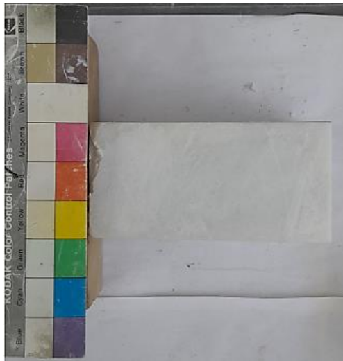
Εικόνες 4.2.4 Δοκίμια μετά την δοκιμή άμεσης διάτμησης υπό ορθή τάση 800 kPa
