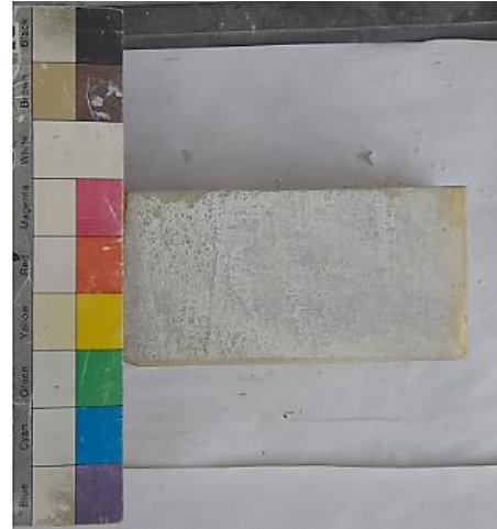
Εικόνες 4.2.6 Δοκίμια μετά την δοκιμή άμεσης διάτμησης υπό ορθή τάση 400 \text{ kPa}
