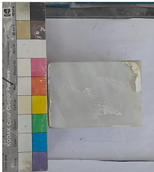
Εικόνες 4.2.19 Δοκίμια μετά την δοκιμή άμεσης διάτμησης υπό ορθή τάση 600 kPa
