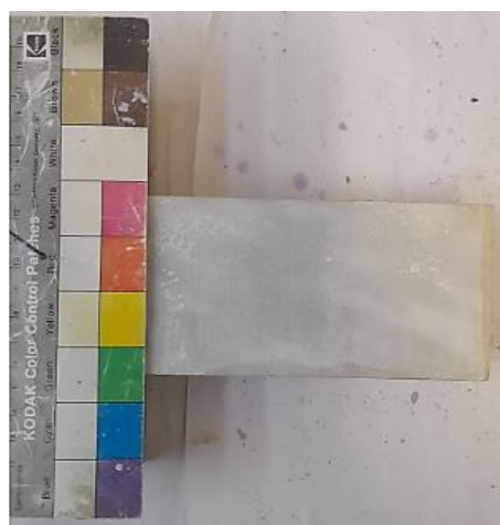
Εικόνες 4.3.1 Δοκίμια μετά την δοκιμή άμεσης διάτμησης υπό ορθή τάση 200 kPa
