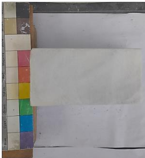
Εικόνες 4.2.3 Δοκίμια μετά την δοκιμή άμεσης διάτμησης υπό ορθή τάση 600 kPa
