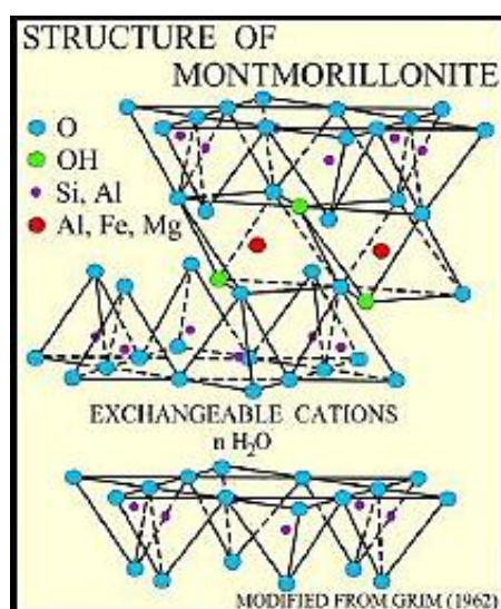
Εικόνα 3.5.2.1.2 Κρυσταλλική δομή μοντμοριλλονίτη
