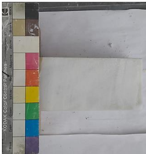
Εικόνες 4.2.9 Δοκίμια μετά την δοκιμή άμεσης διάτμησης υπό ορθή τάση 200 kPa
