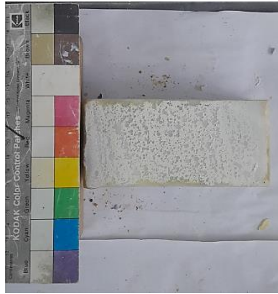
Εικόνες 4.2.13 Δοκίμια μετά την δοκιμή άμεσης διάτμησης υπό ορθή τάση 200 \text{ kPa}
