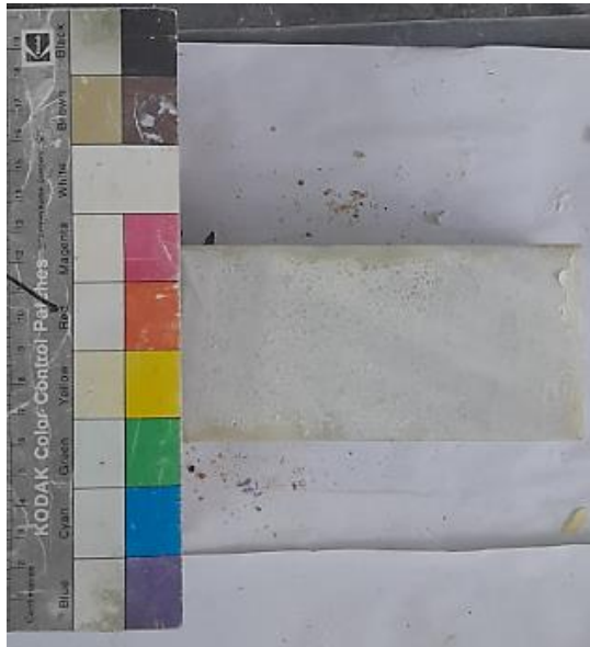
Εικόνες 4.2.13 Δοκίμια μετά την δοκιμή άμεσης διάτμησης υπό ορθή τάση 200 \text{ kPa}
