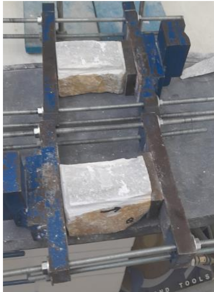
Εικόνα 3.7.1.2 Τοποθέτηση των δοκιμίων στις μήτρες
