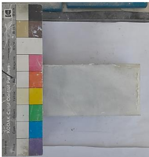
Εικόνες 4.2.17 Δοκίμια μετά την δοκιμή άμεσης διάτμησης υπό ορθή τάση 200 kPa
