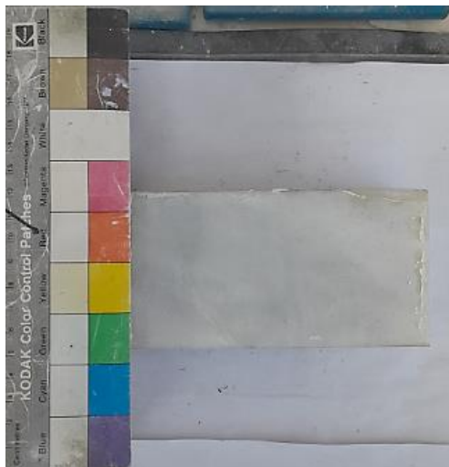
Εικόνες 4.2.1 Δοκίμια μετά την δοκιμή άμεσης διάτμησης υπό ορθή τάση 200\text{kPa}
