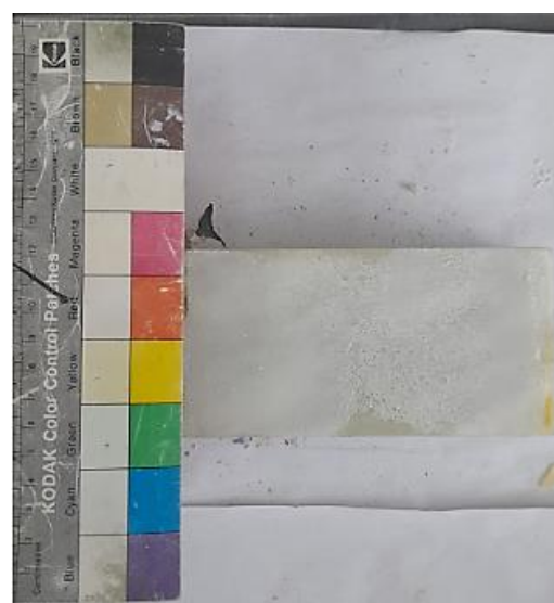
Εικόνες 4.2.14 Δοκίμια μετά την δοκιμή άμεσης διάτμησης υπό ορθή τάση 400 \text{ kPa}
