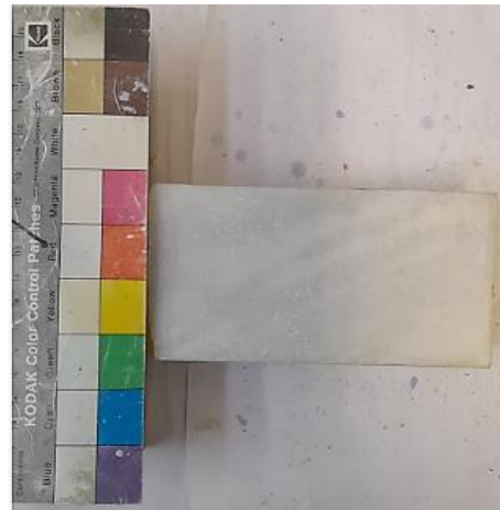
Εικόνες 4.3.2 Δοκίμια μετά την δοκιμή άμεσης διάτμησης υπό ορθή τάση 500 kPa
