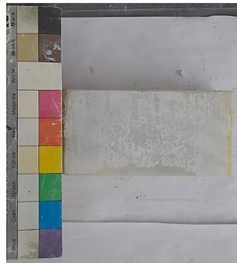
Εικόνες 4.2.5 Δοκίμια μετά την δοκιμή άμεσης διάτμησης υπό ορθή τάση 200 \text{ kPa}
