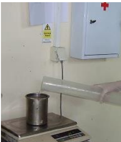
Εικόνα 3.5.2 Προσθήκη νερού με την χρήση ογκομετρικού κυλίνδρου
