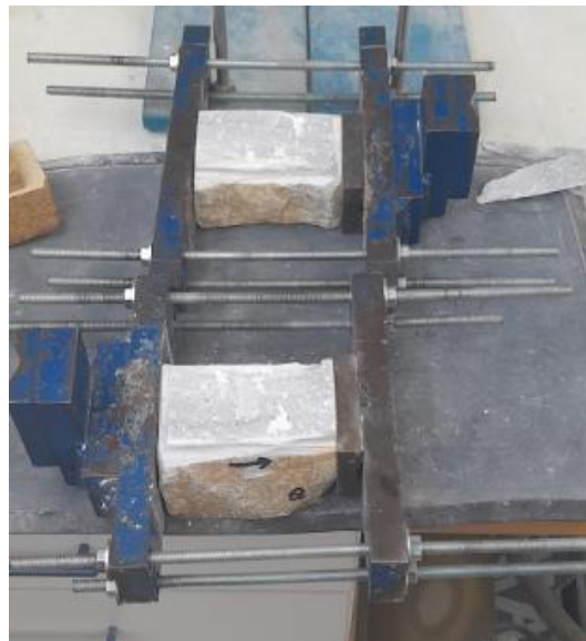
Εικόνα 3.7.1.1 Μήτρες τοποθέτησης δοκιμίων άμεσης διάτμησης ασυνχειών.
