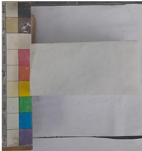
Εικόνες 4.2.2 Δοκίμια μετά την δοκιμή άμεσης διάτμησης υπό ορθή τάση 400 kPa
