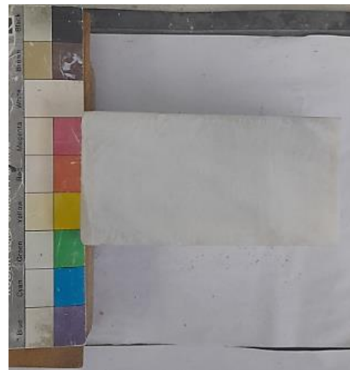
Εικόνες 4.2.3 Δοκίμια μετά την δοκιμή άμεσης διάτμησης υπό ορθή τάση 600 kPa
