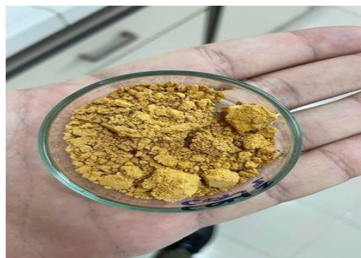
Εικόνα 11: Δείγμα σκόνης που έχει παραμείνει στον κλίβανο ξήρανσης έπειτα από 24 h.
