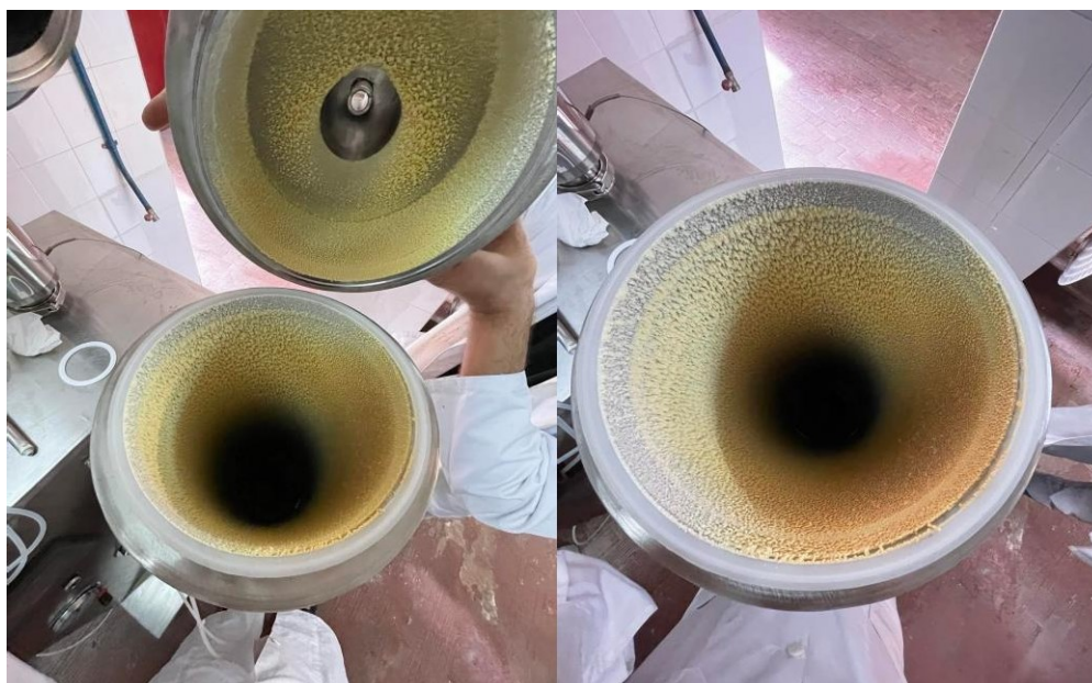
Εικόνα 10: Εσωτερικού θαλάμου ξήρανσης μετά την ολοκλήρωση της ξήρανσης, με τις επικαθήσεις προϊόντος που σχηματίστηκαν στα τοιχώματα του θαλάμου
