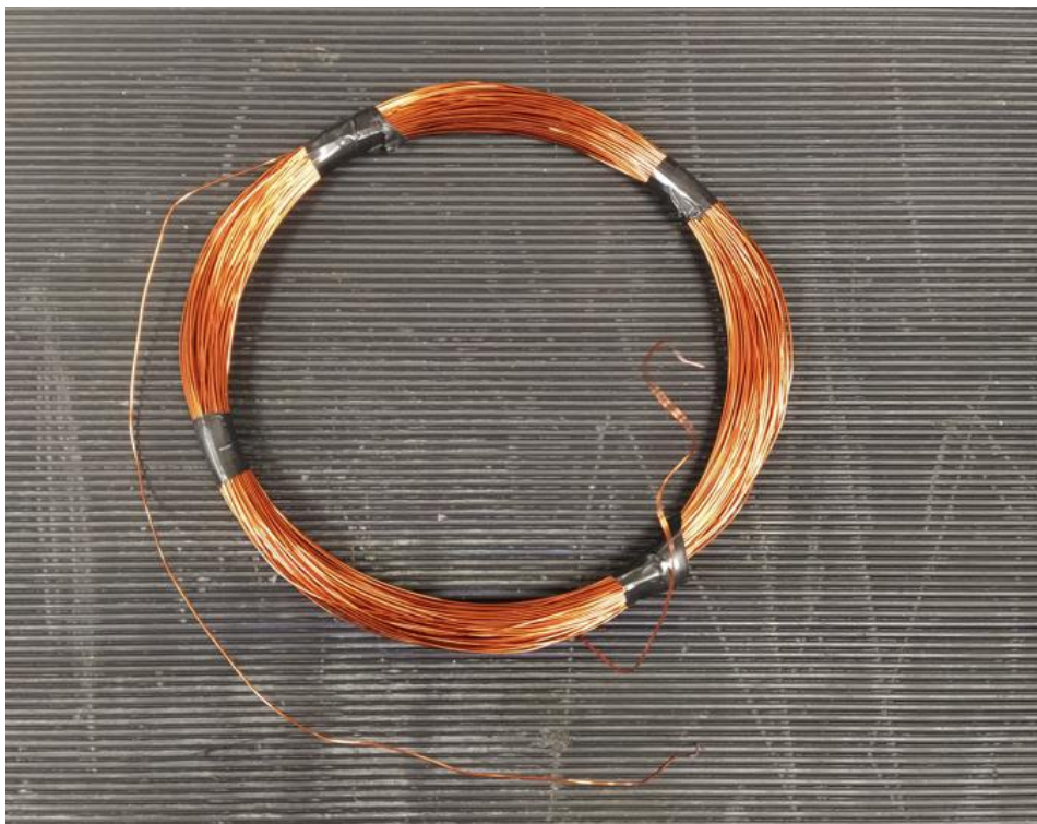
Σχήμα 3.5 Πηνίο 140 στροφών 18cm διάμετρο και 0.75mm 2 διατομή
