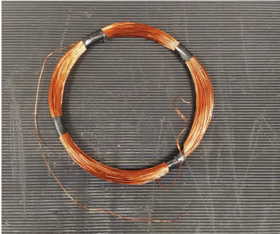
Σχήμα 4.1 Πηνίο 140 στροφών 18cm διάμετρο και 0.75mm 2 διατομή
