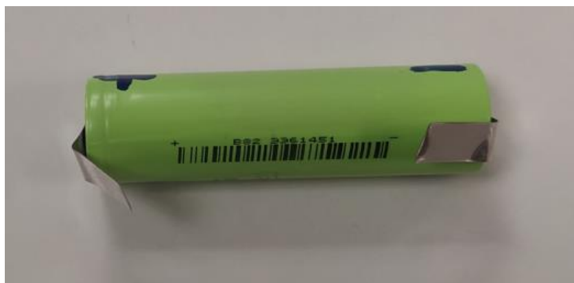
Σχήμα 3.8 μπαταρία 18650 lion 3.6 V 2900 mAh
