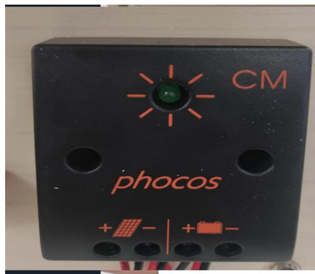
Σχήμα 3.3 Ελεγκτής Ηλιακής Φόρτισης phocos CM
