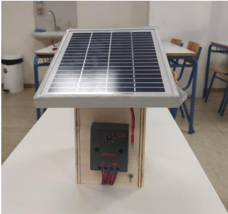
Σχήμα 5.1 Κατασκευή βάσης στήριξης Ηλιακού πάνελ και ελεγκτή φόρτισης
