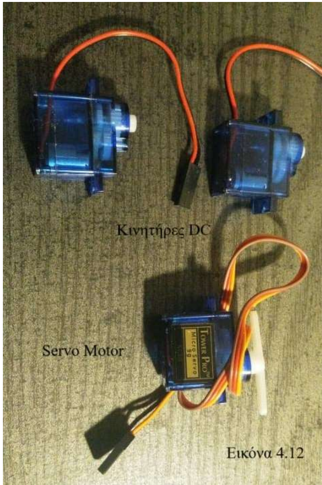
Εικόνα 4.12: Κινητήρες DC (κινούν τους οπίσθιους τροχούς) και κινητήρας Servo (κινεί την μονάδα μέτρησης αποστάσεων)
