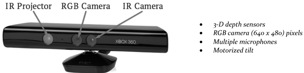
Σχήμα 21 - Αισθητήρας Kinect® και χαρακτηριστικά.
