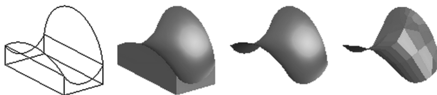
Σχήμα 12 – Κατηγοριοποίηση ψηφιακών γεωμετριών. Από αριστερά προς δεξιά: 3D Wireframe, 3D Solid, 3D Surface, 3D Mesh.
