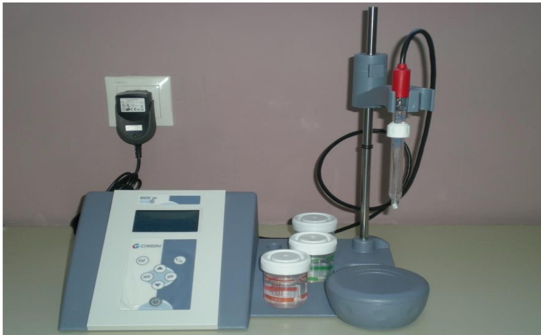
Εικόνα 2.7 pH-μετρο και αγωγιμόμετρο (κυρίως όργανο, ηλεκτρόδιο και πρότυπα διαλύματα για τη ρύθμιση του οργάνου) στο Εργαστήριο Εδαφολογίας του ΑΤΕΙΘ
