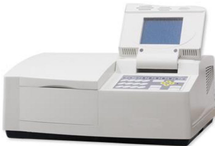
Εικόνα 2.9 Φασματοφωτόμετρο UV – Vis στο Εργαστήριο Εδαφολογίας του ΑΤΕΙΘ
