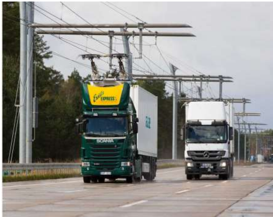
Εικόνα 18: Siemens e-Highway στη Σουηδία (Mark Kane, 2018)
