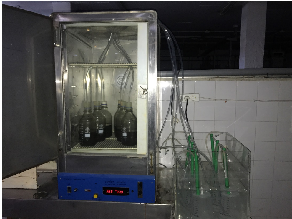
Εικόνα 7. Διάταξη μέτρησης παραγωγής δυναμικού βιοαερίου
