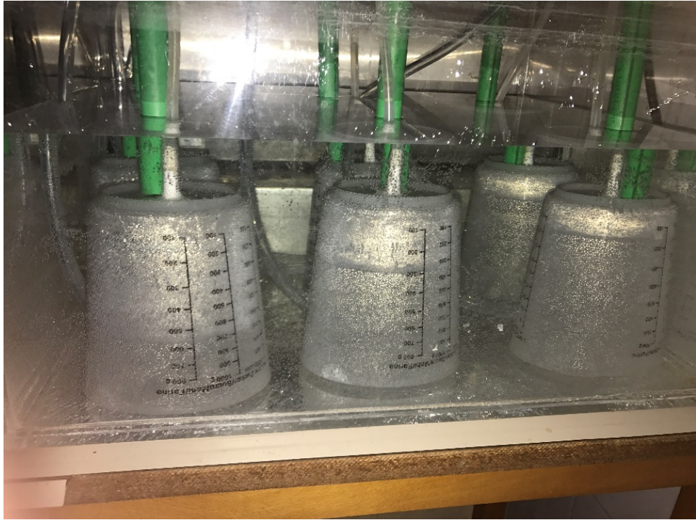
Εικόνα 8. Απεικόνιση του εγκλωβισμένου βιοαερίου με σκοπό την καταμέτρησή του και δυνατότητα συλλογής του
