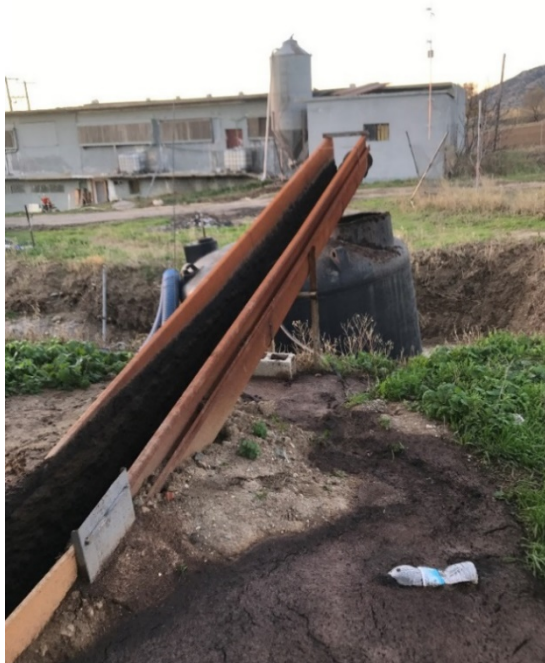
Εικόνα 11. Κοχλίας μεταφοράς κοπριάς σε δεξαμενή αποθήκευσης με δυνατότητα αραίωσης με νερό (12t) από Όρνιθες κλωβοστοιχίας από εταιρεία αγωπααραγωγής στην περιοχή της Νεοχωρούδας (φωτογραφίες κατά τη συλλογή των αποβλήτων)
