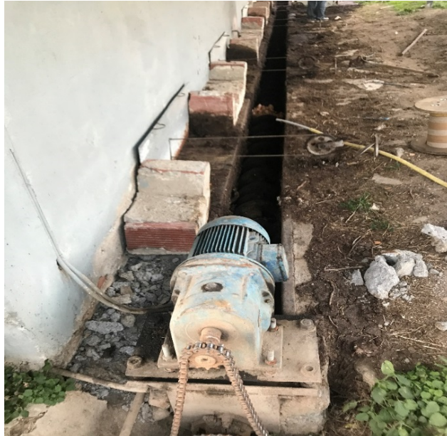
Εικόνα 10. Αντλία συλλογής κοπριάς από Όρνιθες κλωβοστοιχίας από εταιρεία αγωπααραγωγής στην περιοχή της Νεοχωρούδας (φωτογραφίες κατά τη συλλογή των αποβλήτων)
