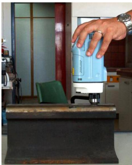
Εικόνα 63. Διάταξη FOM για έλεγχο σε σιδηροτροχιά. (Πηγή: Μοροπούλου, 2014)
