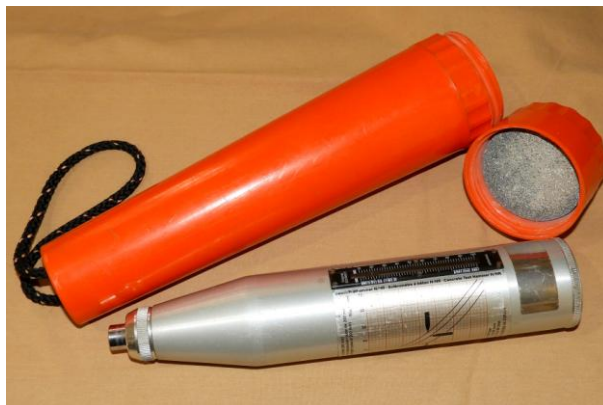
Εικόνα 65. Κρουσίμετρο Schmidt τύπου N. (Φωτ.: Μαρνέλλου, 2020)
