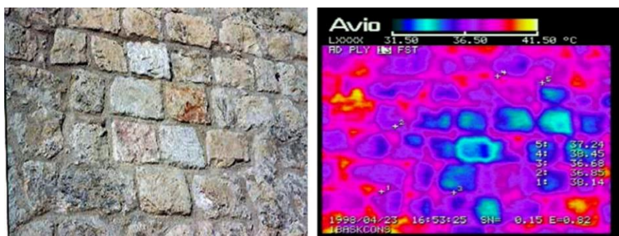
Εικόνα 39. Τμήμα λιθοδομής από τα Ενετικά Τείχη του Ηρακλείου Κρήτης (αριστερά: φυσική φωτογραφία, δεξιά: θερμογράφημα). (Πηγή: Μοροπούλου et al. , 2013)
