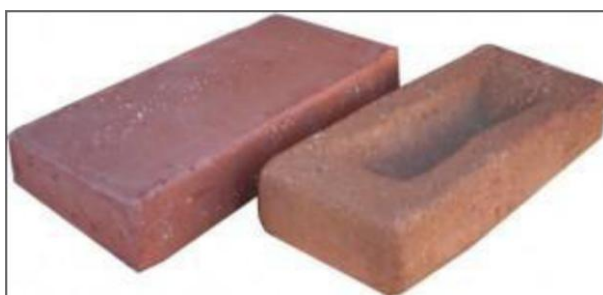
Εικόνα 26. Τύποι παραδοσιακών ιστορικών οπτοπλίνθων (συμπαγής και με σκάφη). (Πηγή: Μοροπούλου, 2014)
