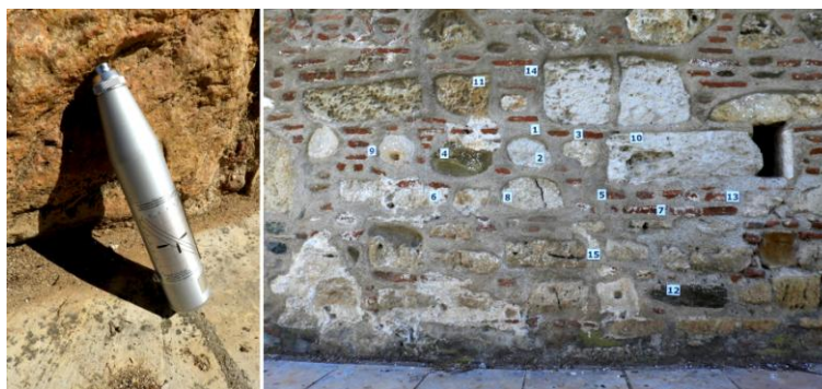
Εικόνα 85. Κρουσιμέτρο και σήμανση θέσεων δοκιμής στη ΒΔ όψη του Α.Πύργου. (Φωτ.: Μαρνέλλου, 2020)
