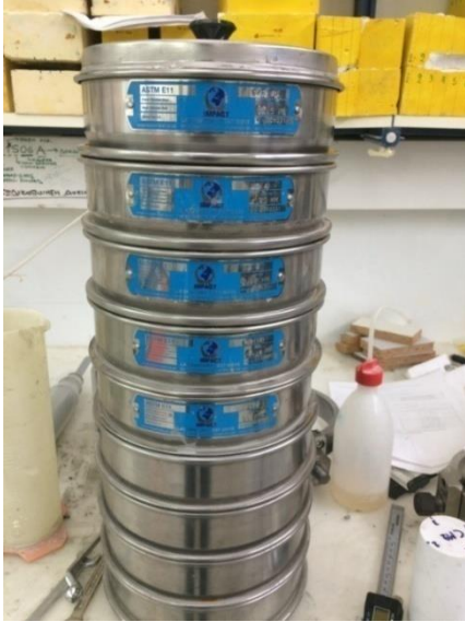
Εικόνα 23. Στήλη κοκκομετρίας για την κλασμάτωση μεγεθών των κονιοροποιημένων κελυφών μυδιών στο εργαστήριο.
