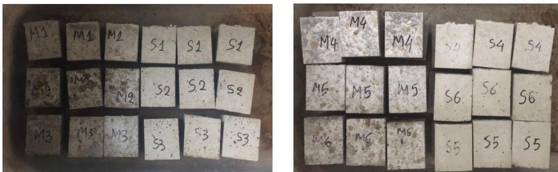
Εικόνα 27. Αποθήκευση και συντήρηση των συμβατικών (S 1 , S 2 κ.λ.π) αλλά και των πειραματικών (M 1 , M 2 κ.λ.π) δοκιμών στο εργαστήριο.
