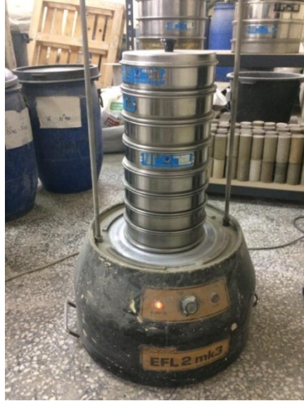
Εικόνα 23. Στήλη κοκκομετρίας για την κλασμάτωση μεγεθών των κονιοροποιημένων κελυφών μυδιών στο εργαστήριο.
