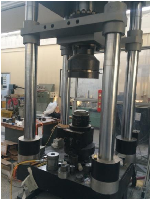
Εικόνα 28. Πρέσα θραύσης δοκιμίων στο χώρο του εργαστηρίου.
