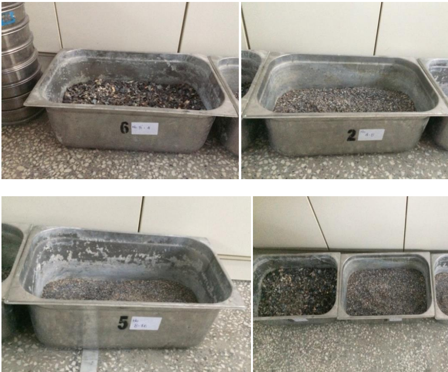
Εικόνα 24. Παρασκευή κλασμάτων κοσκίνου κονιοροποιημένων χρησιμοποιούμενων κελυφών μυδιών στο εργαστήριο.
