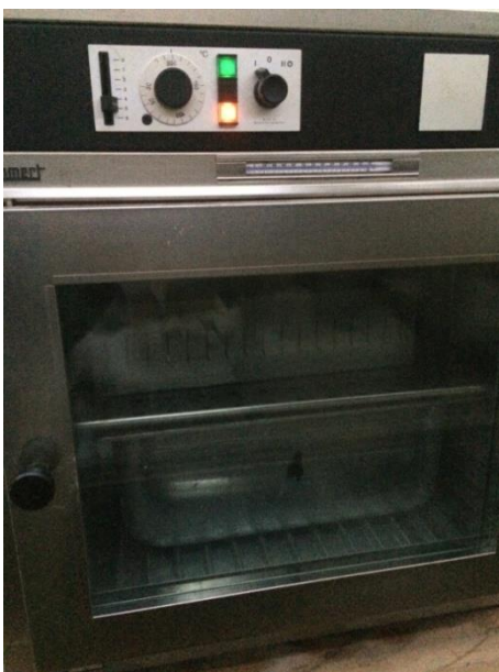
Εικόνα 17. Διαδικασία ξήρανσης χρησιμοποιούμενων κελυφών μυδιών στο εργαστήριο.
