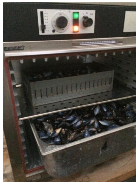
Εικόνα 17. Διαδικασία ξήρανσης χρησιμοποιούμενων κελυφών μυδιών στο εργαστήριο.
