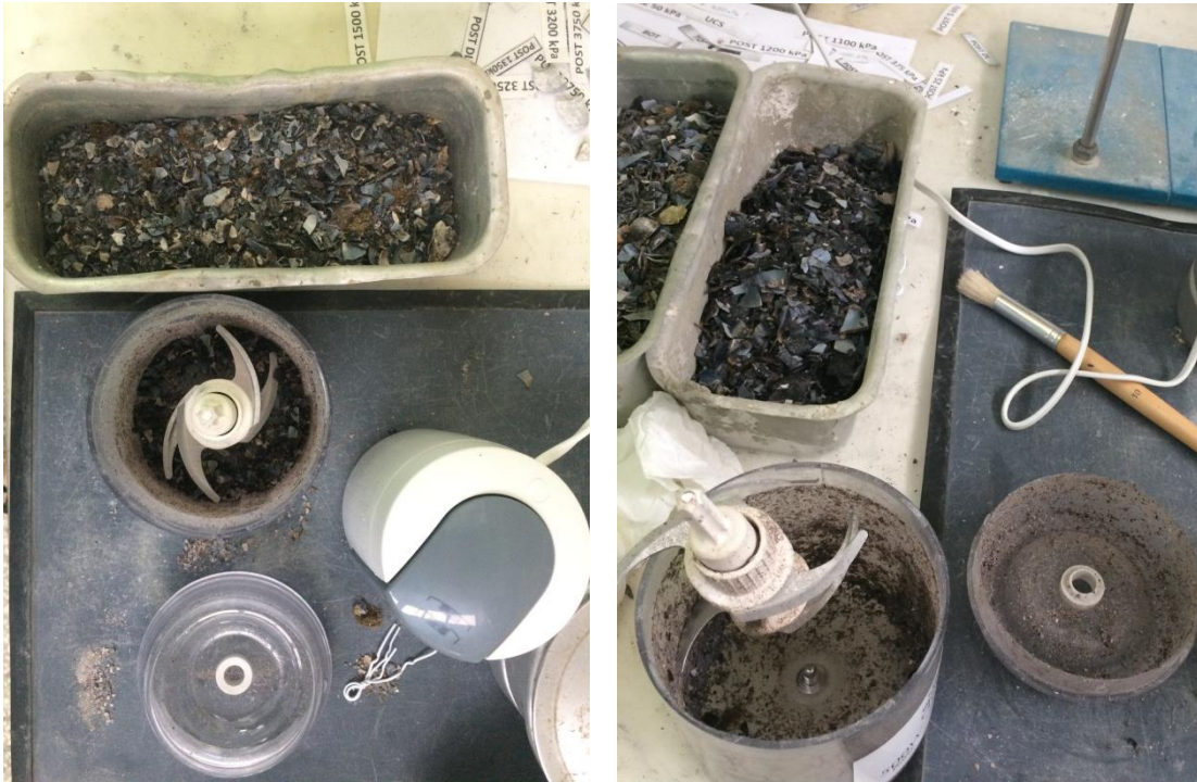
Εικόνα 18. Διαδικασία κονιορτοποίησης ξηραμένων χρησιμοποιούμενων κελυφών μυδιών στο εργαστήριο.
