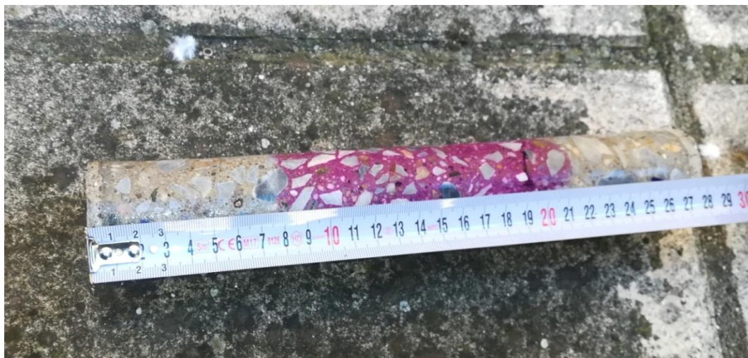
Εικόνα 24: Πυρήνας ύστερα από την χρήση φαίλονοφθαλεΐνης
