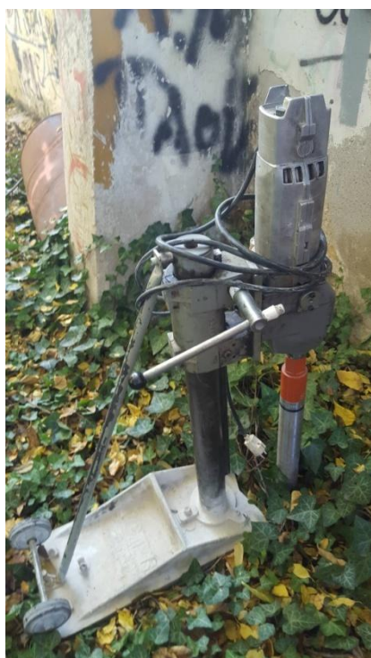
Εικόνα 25: Καροτιέρα με κορώνα 5 cm
