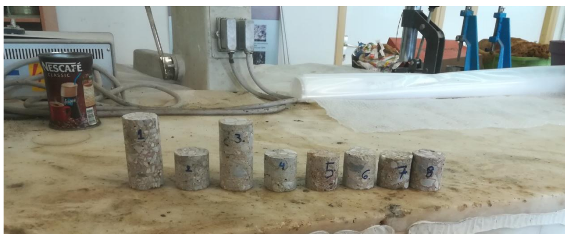
Εικόνα 36: Πυρήνες διαμέτρου 5 cm έτοιμοι για θραύση
