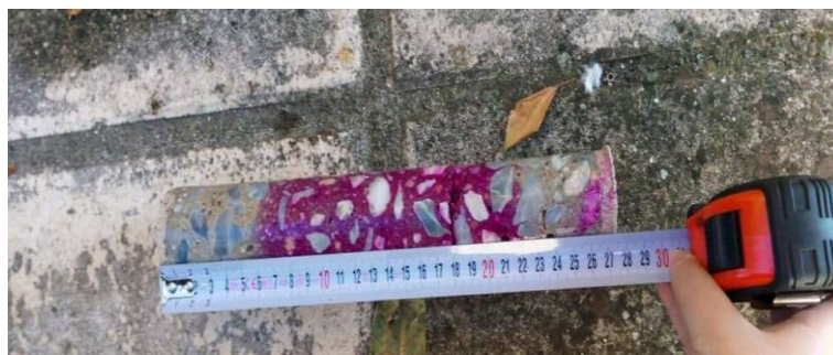
Εικόνα 30: Πυρήνας διαμέτρου 5 cm
