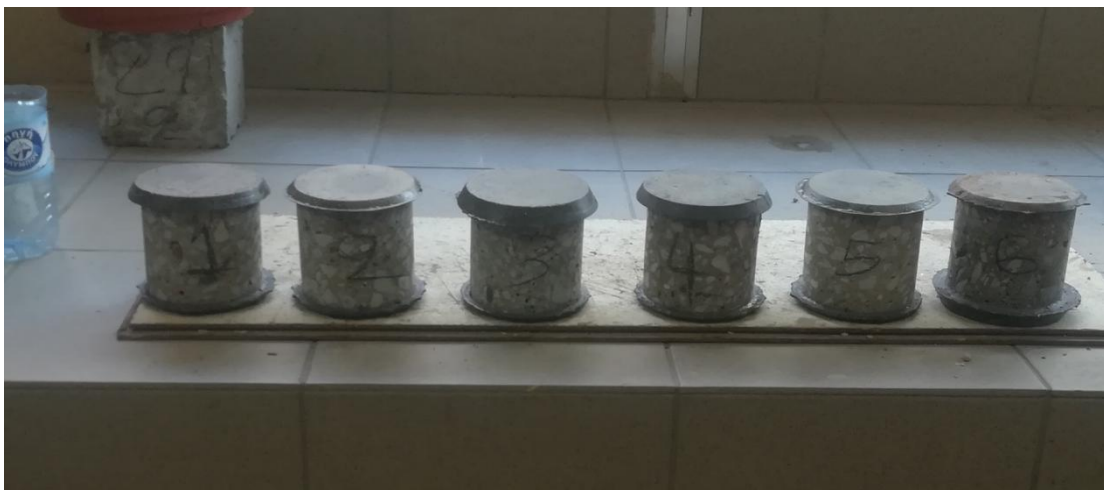
Εικόνα 33: Πυρήνες διαμέτρου 10 cm έτοιμοι για θραύση
