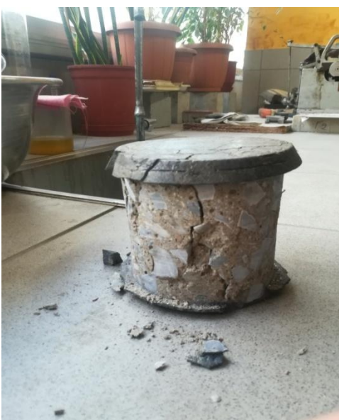
Εικόνα 35: Πυρήνας μετά την θραύση
