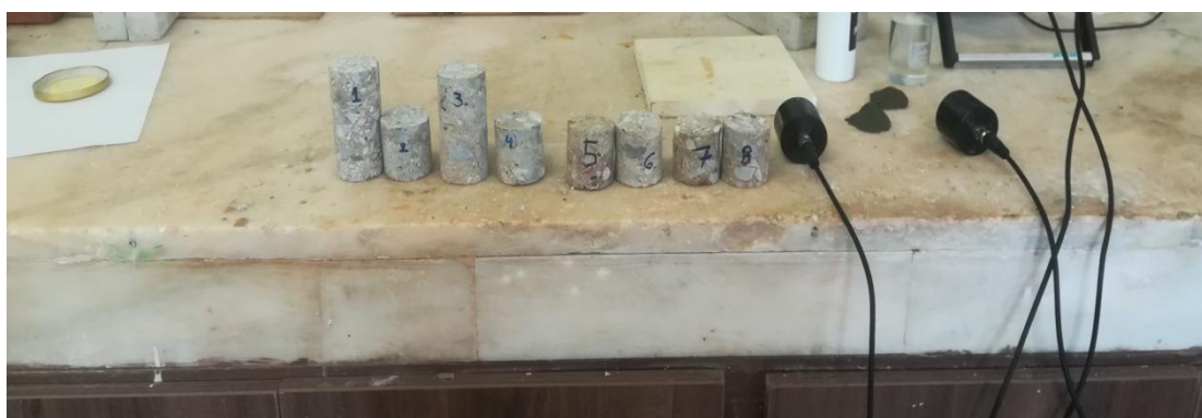
Εικόνα 31: Πυρήνες στο εργαστήριο για σονομέτρηση
