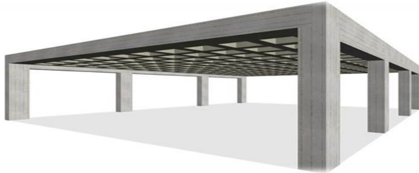
Σχήμα 5: Δοκιδωτή πλάκα μιας κατεύθυνσης.
