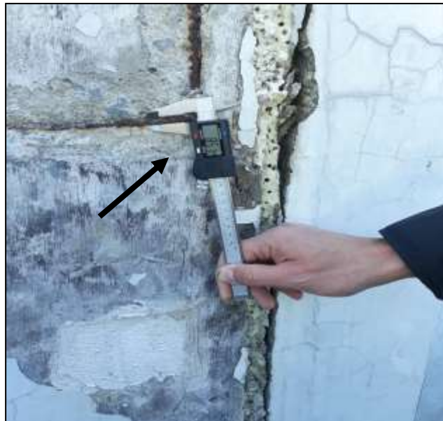
Εικόνα 26 Μέτρηση διαμέτρου οπλισμού - Ένδειξη 8.51 cm
