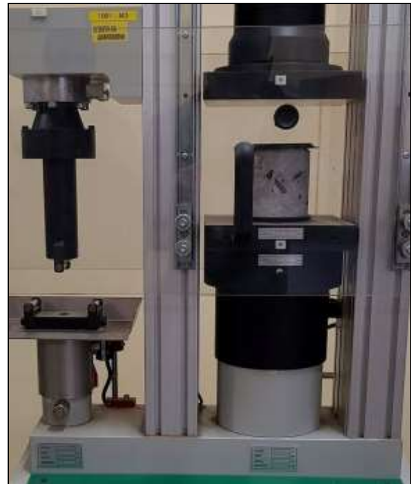
Εικόνα 49 Σύνθλιψη δοκιμίου στην πρέσα
