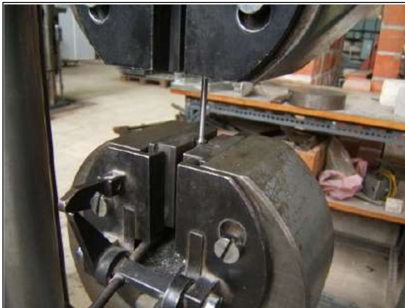
Εικόνα 3 Δοκιμή εφελκυσμού χαλύβδινης ράβδου
