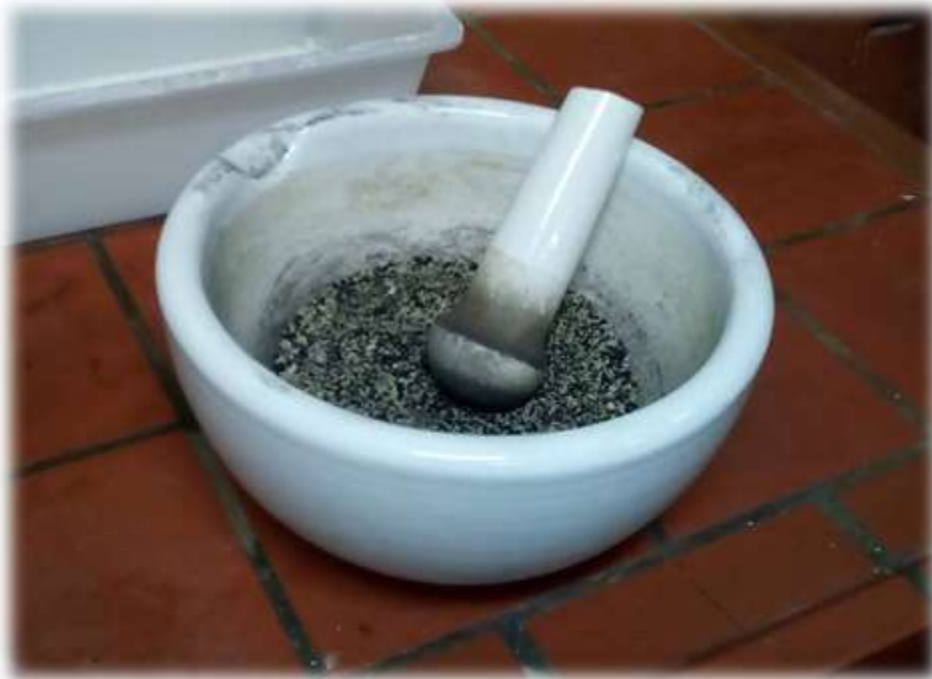
Εικόνα 2.1. Άλεση βιοεξανθρακώματος σε πορσελάνινο γουδι.
