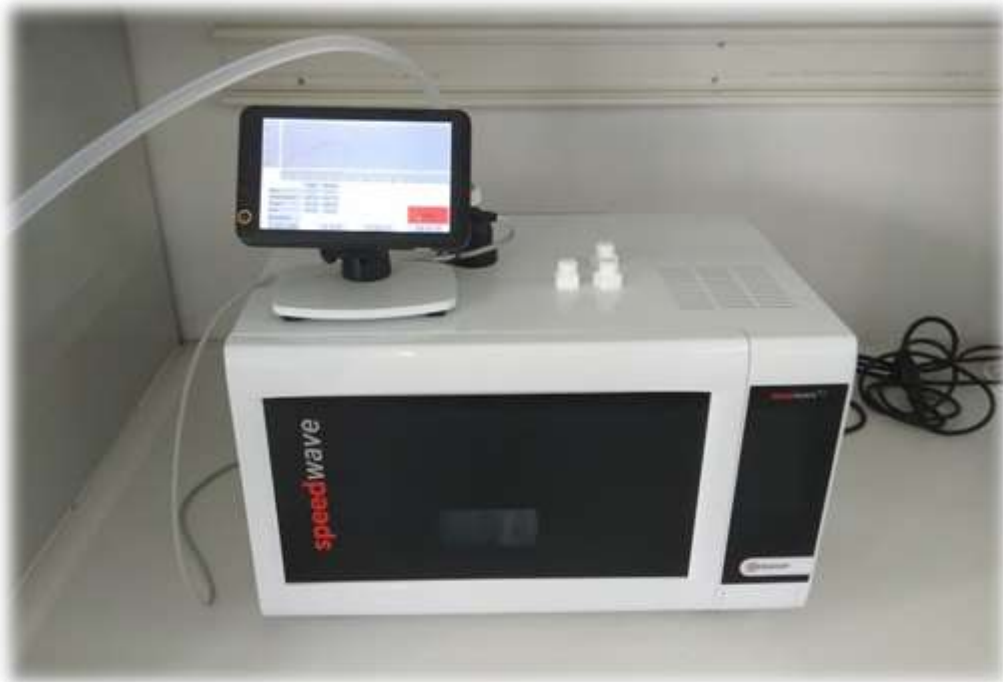
Εικόνα 16. Ο εξοπλισμός που χρησιμοποιήθηκε κατά τη διαδικασία της πέψης είναι το speedwavetwo, DAP-60K της BerghofProducts + InstrumentsGmbH.
