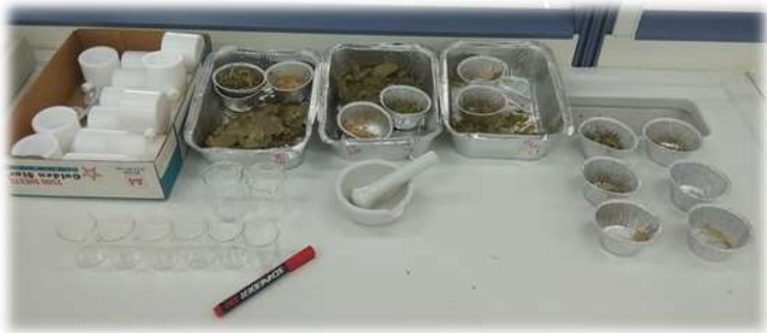
Εικόνα 13. Άλεση των αποξηραμένων φυτικών ιστών και προετοιμασία των δειγμάτων που προορίζονται για πέψη.
