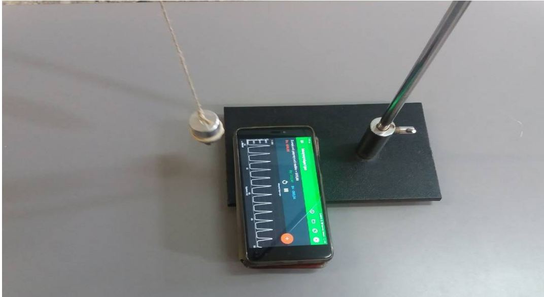
Εικόνα 3.22. Ταλάντωση εκκρεμούς με τον αισθητήρα μαγνητόμετρο στη μια ακραία θέση
