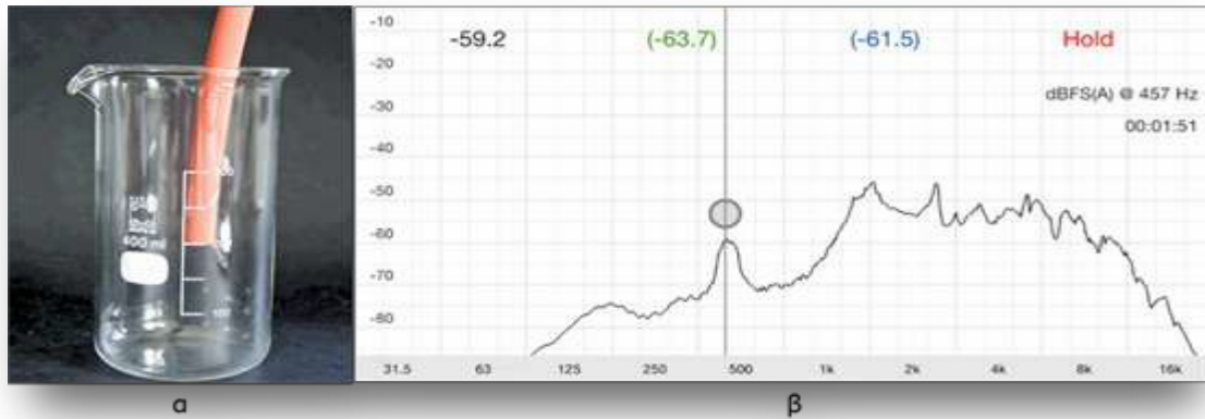
Εικόνα 2.7. Μέτρηση του ήχου σε αέρια α) Το δοχείο με το CO 2 β) Το φάσμα συχνοτήτων του CO 2 (Monteiro et al., 2015)
