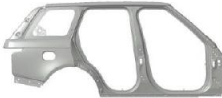
Εικόνα 43 – Ενιαία πλαϊνή πλευρά αμαξώματος[38]
