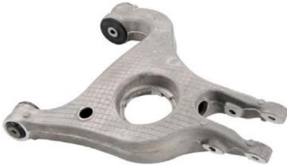
Εικόνα 33 – Βραχίονας ανάρτησης από χυτό κράμα 42000 (χύτευση σε μόνιμο καλούπι) [33]
