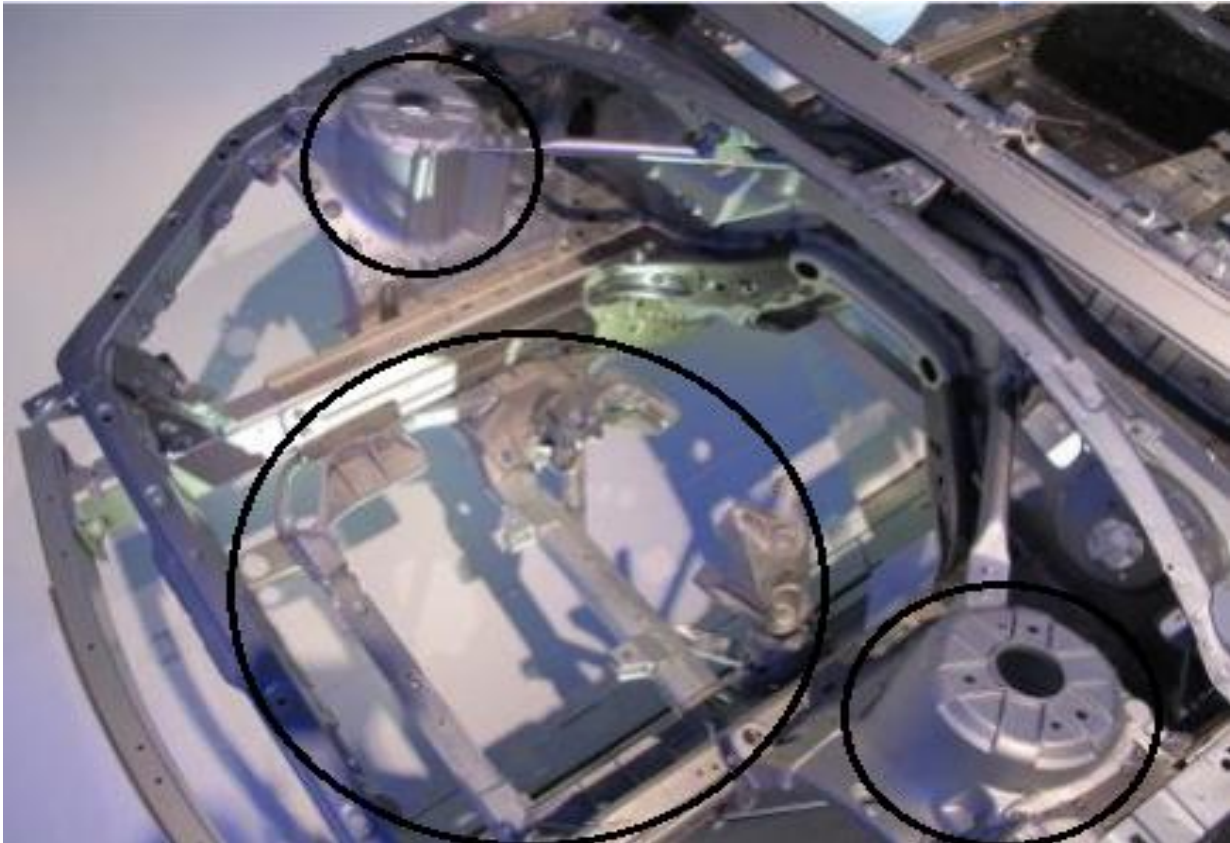
Εικόνα 29 – Άνω βάσεις ανάρτησης (μικροί κύκλοι) και βάση κινητήρα (μεγάλος κύκλος) [32]
