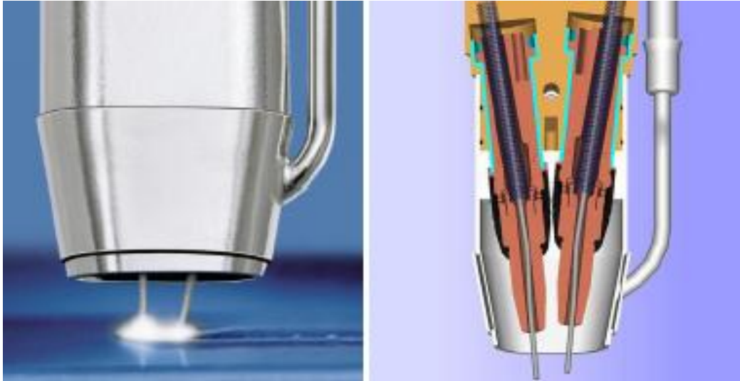
Εικόνα 105 – Ηλεκτροσυγκόλληση MIG διπλού ηλεκτροδίου[42]
