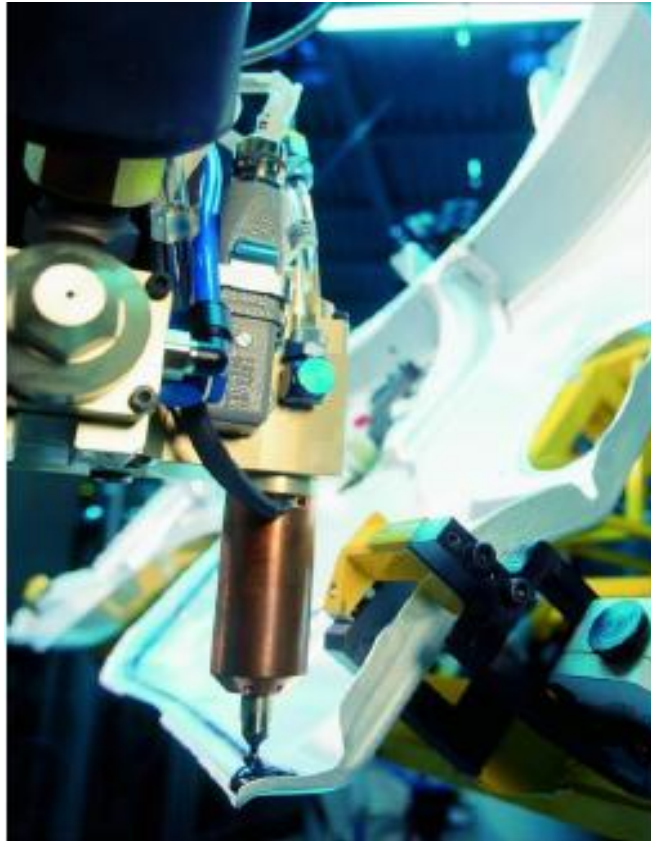
Εικόνα 68 – Αυτοματοποιημένη διαδικασία τοποθέτησης κόλλας σε τεμαχίο αλουμινίου[39]
