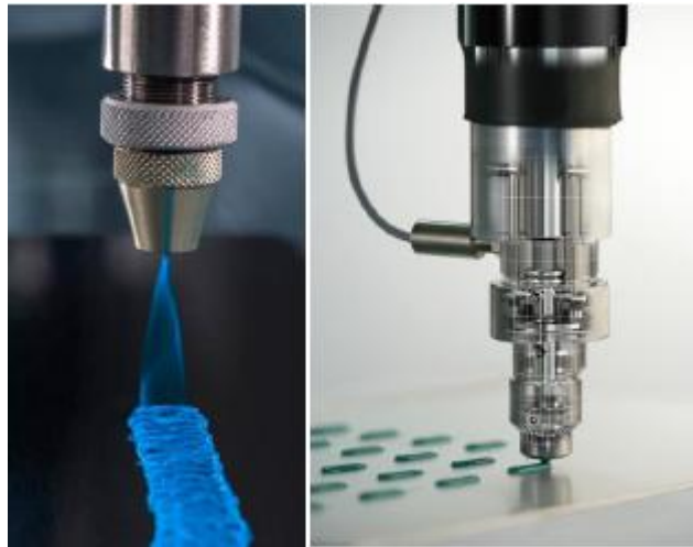
Εικόνα 83 – Ελικοειδής ψεκασμός (αριστερά) και βραχέων σφαιριδίων (δεξιά) [39]
