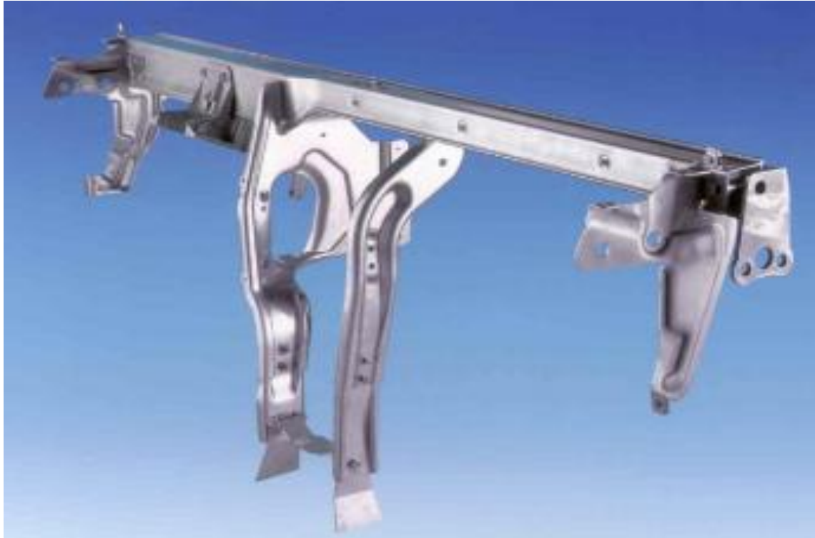
Εικόνα 22 – Βάση πίνακα οργάνων-ζώνη σύγκρουσης[32]
