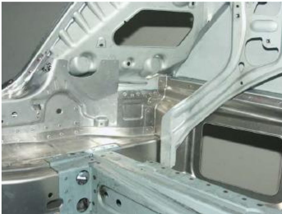
Εικόνα 84 – Σύνδεση μέσω ήλων μεταξύ αλουμινίου και χάλυβα [35]
