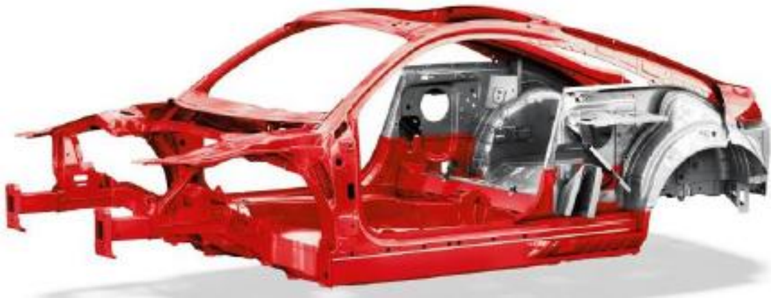
Εικόνα 64 – Αμάξωμα με συνδυασμό χάλυβα-αλουμινίου[38]
