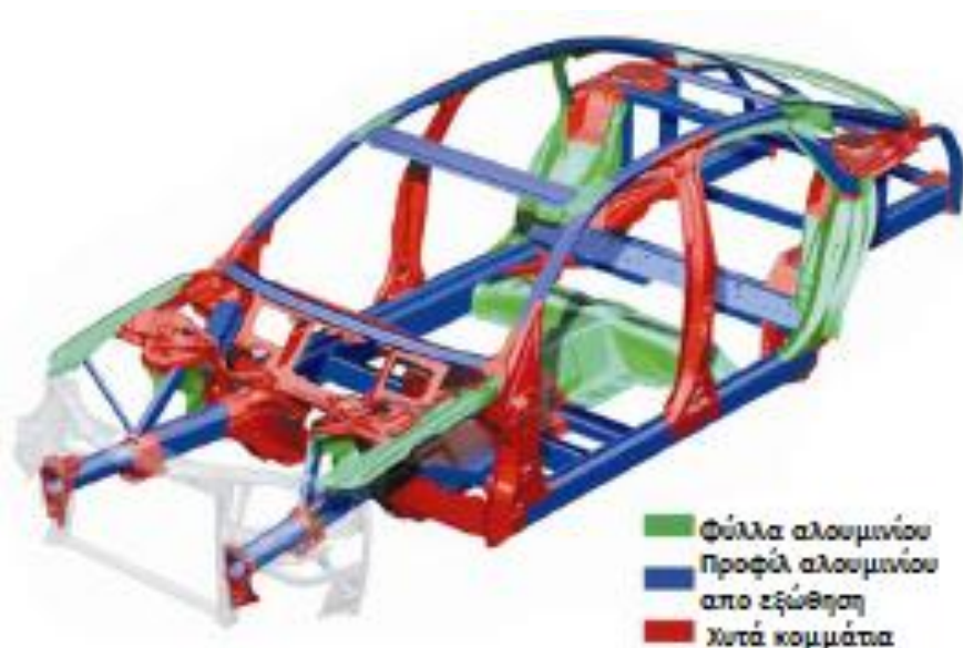
Εικόνα 54 – Αμάξωμα χωροδικτυώματος με επιμέρους τύπους υλικών[38]
