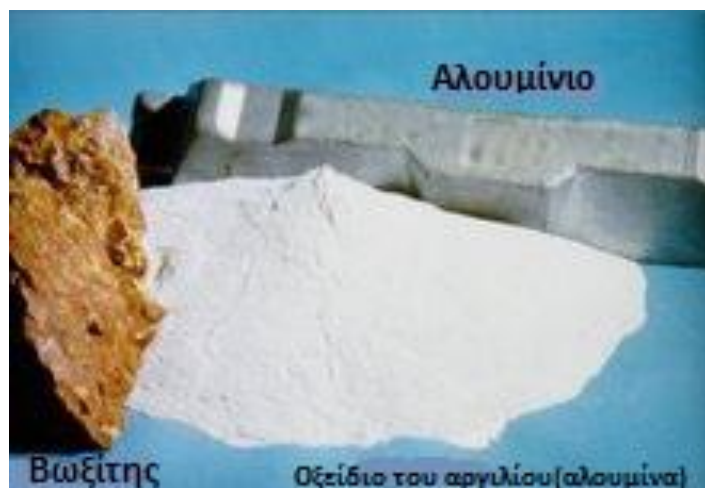
Εικόνα 5 – Το υλικό κατά τα 2 στάδια επεξεργασίας [7]
