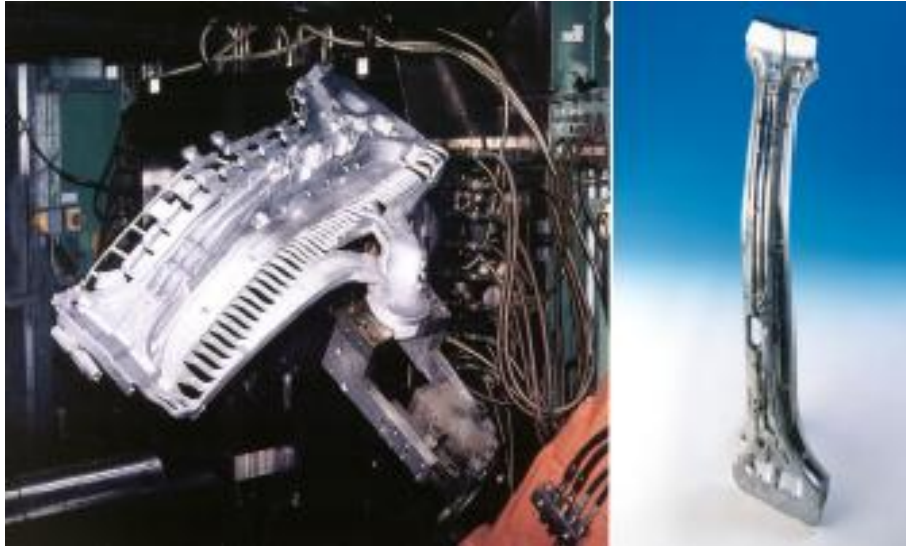
Εικόνα 45 – Κολώνα αμαξώματος και η διαδικασία χύτευσης της[35]
