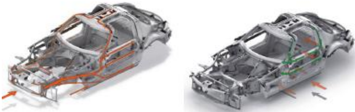
Εικόνα 60 – Ροή δυνάμεων κατά τη σύγκρουση[38]
