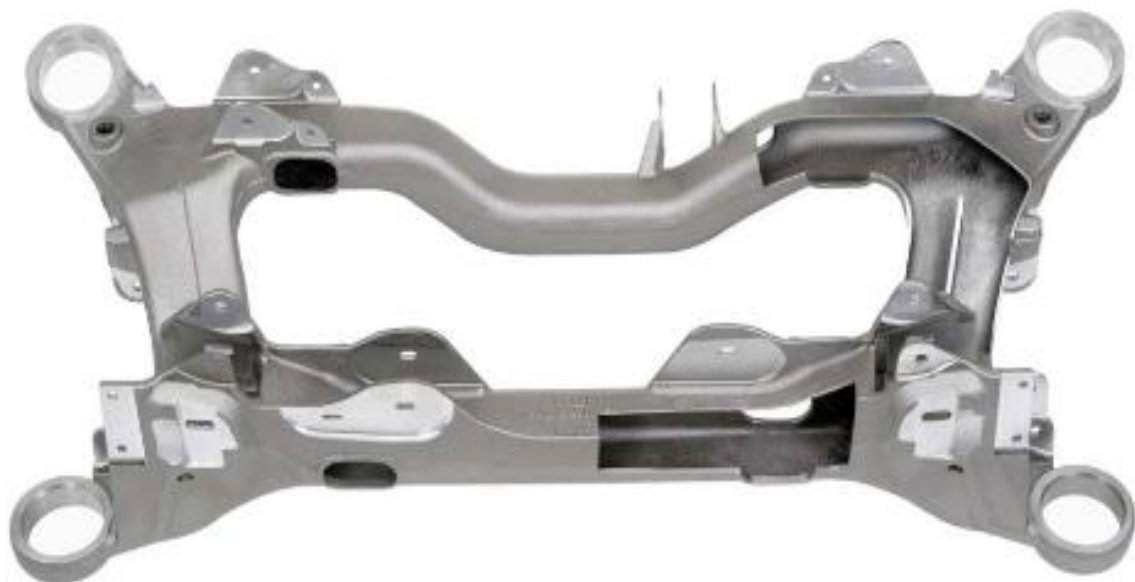
Εικόνα 35 – Τυπικό παράδειγμα υποπλαisiού οπίσθιου άξονα από κράμα χύτευσης [34]
