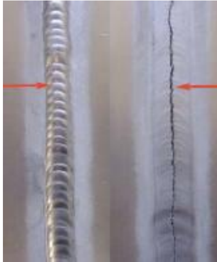
Εικόνα 96 – Συγκόλληση TIG με τηκόμενο ηλεκτρόδιο (αριστερά) και χωρίς (δεξιά) [41]
