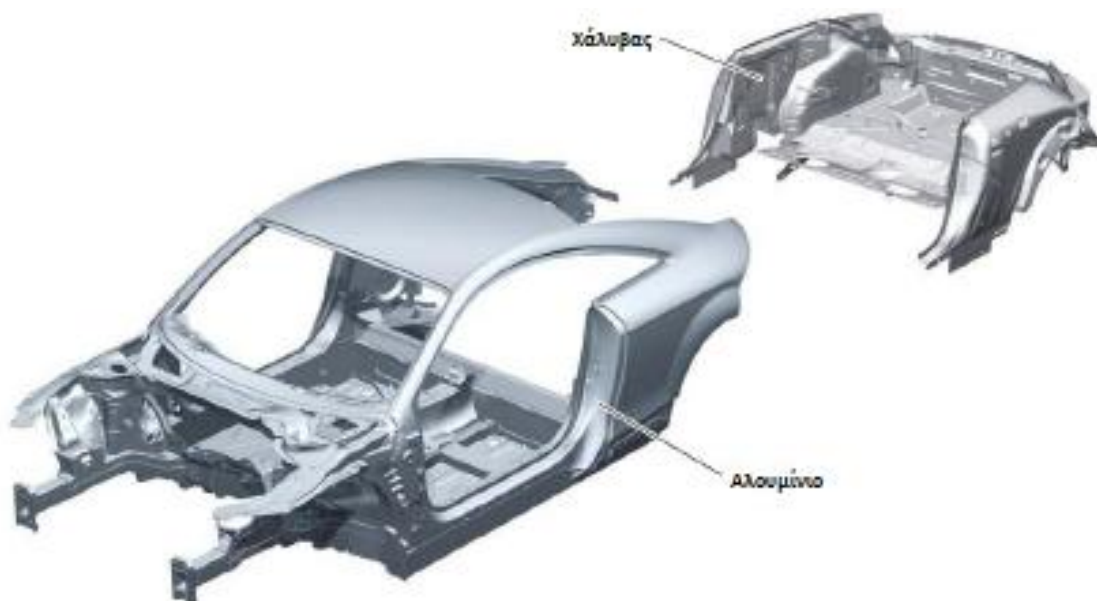
Εικόνα 66 – Διαχωρισμός τμημάτων από αλουμίνιο και χάλυβα σε αμάξωμα[38]
