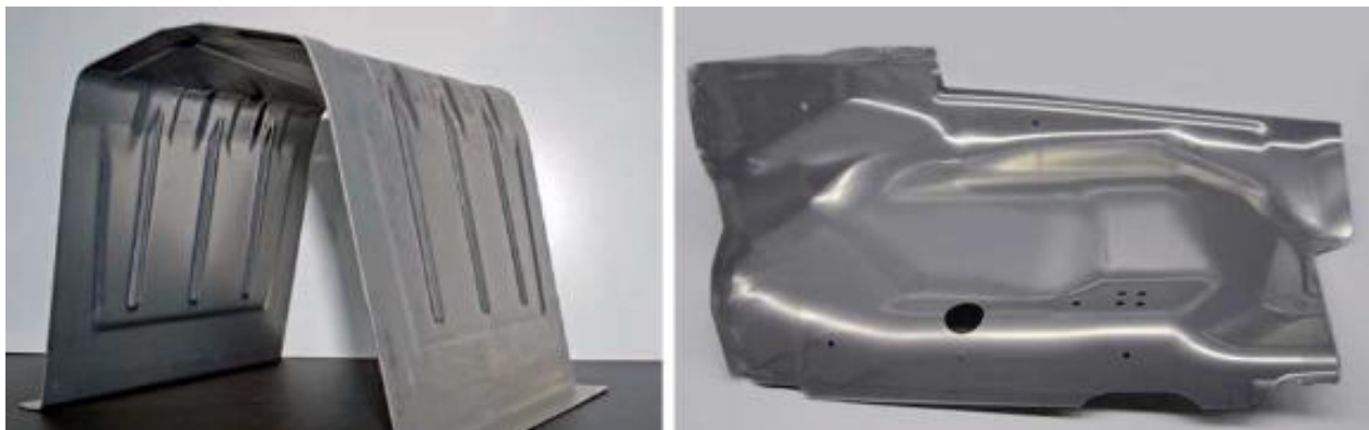
Εικόνα 27 – Αριστερά: Κάλυμμα κεντρικού τούνελ, Δεξιά: Λοιπό τμήμα από το κάλυμμα του πατώματος (Κράμα σειράς 5XX00) [32]
