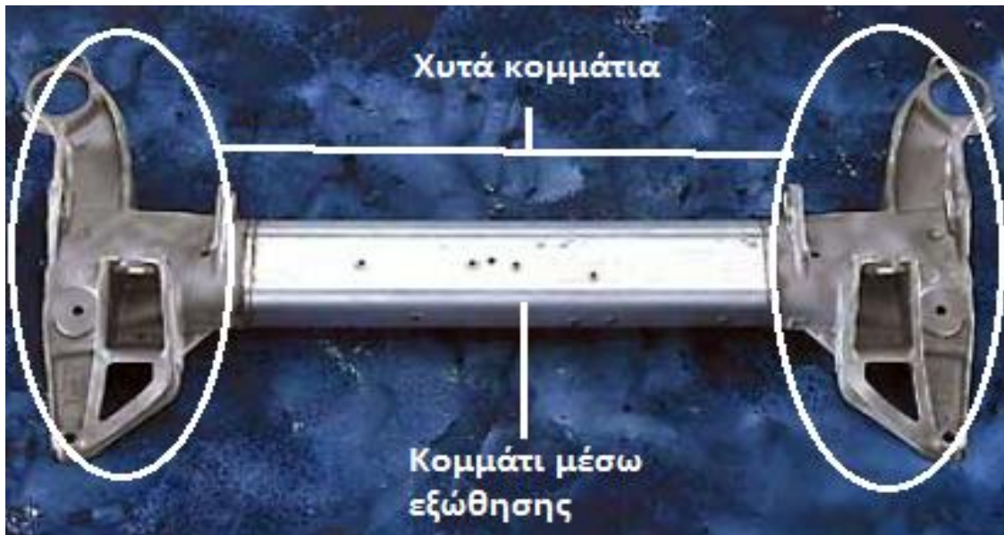
Εικόνα 37 – Υποπλαίσιο οπίσθιου άξονα με συνδυασμό χυτών και εξωθημένων κομματιών [34]
