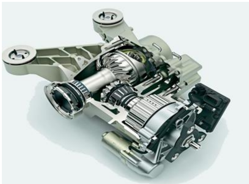
Σχ.4.2 Διαφορικό τύπου Haldex σε τομή.
